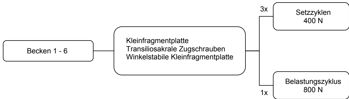
Abb.33: Versuchsablauf mit Belastungsschema für die Kunststoffmodelle
