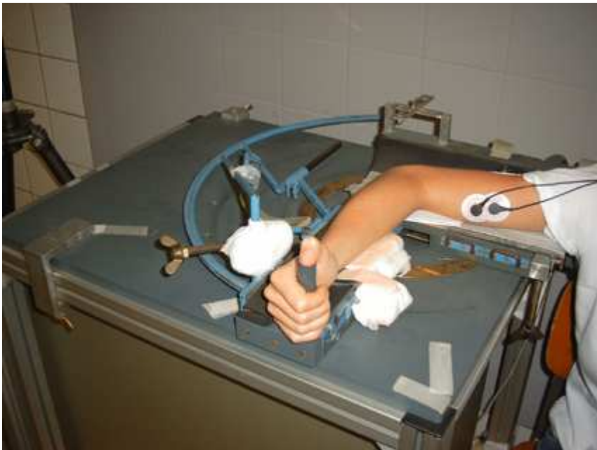
Abb.3.1 Probandin an der Versuchsanordnung. Der Arm liegt korrekt auf der Schiene, die Hand umfasst den Griff, um die Schiene bewegen zu können.
