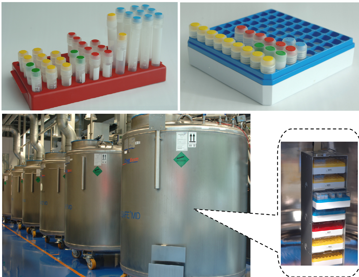
Abbildung 5: Konventionelle Kryotechnologie. Oben links: konventionelle Probenröhrchen für die Kryokonservierung von Zellen, aufgesteckt auf einen Laborständer. Die Volumina der abgebildeten Röhrchen variieren zwischen 1ml und 5ml. Farbige Schraubverschlüsse können verwendet werden, um verschiedene Probentypen farblich zu kodieren. Oben rechts: eine Kryo-Schublade, teilweise bestückt mit Kryoröhrchen. Ein zusätzlicher transparenter Deckel mit aufgedruckten Positionsnummern erlaubt visuelle Lokalisierung und bietet Schutz gegen Herausfallen. Unten rechts: Die Schubladen werden in Kryo-Lagertürmen ( Racks ) gestapelt. Diese werden in Kryo-Lagertanks langzeitgelagert. Unten links: handelsübliche Kryo-Lagertanks in der Forschungs- und Demonstrationsbiobank der Fraunhofer-Gesellschaft in Sulzbach/Saar. Proben werden in Stickstoff-Gasphase
