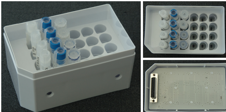
Abbildung 30: Verschiedene Blickwinkel auf eine Lagerbox für 24 GHRC-Substrate oder adaptierte Standard-Kryoröhren mit jeweils 2 ml Volumen. Die Positionen und Steckverbinder zur Aufnahme der Sockel sind in 6 Spalten und 4 Reihen angeordnet. Das elektronische PCB-Board dient als Interface zwischen seriellm Flash-Speicherchip der Substrate und elektronischer Tank-Infrastruktur und den in Kapitel 5 beschriebenen Dockingstationen.
