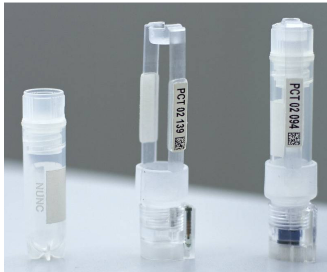
Abbildung 29: Anwendung des Adapters für Standard-Kryoröhren. Links: Standard-Kryoröhren mit einem Volumen von 2ml. Mitte: Adapter („Portlink“, hergestellt von Perma Cryo Technologie GmbH) zum Integrieren von Standard-Kryoröhren in die Technologieplattform. Der Adapter verfügt im Wesentlichen über die gleichen Identifizierungsmerkmale wie das GHRC-Substrat und nutzt die gleichen Sockel. Rechts: adaptiertes Kryoröhren, umschlossen von einem „Portlink“.
