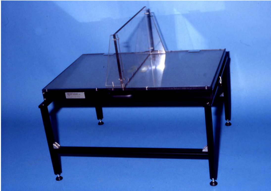
Abbildung 9: RSA-Kalibrierungskäfig für Wirbelsäulenaufnahmen.
