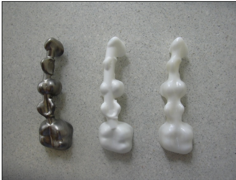
Abb 4 Vergleich von CAD/CAM gefrästen Brücken aus Titan, porös vorgesintertem und dicht gesintertem Zirkonoxid
