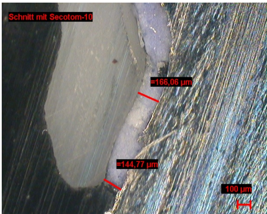
Abb.37 Beispiel einer Randvermessung: Originalvergrößerung 50-fach
