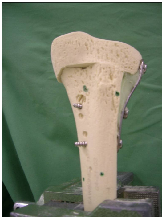
Abbildung 3.9.3.2.3.1 und 3.9.3.2.3.2: Linkes Bild: Knochenzement – unterfütterte lateral schließende Fixierung mittels L –Platte der Firma Sulzer am Beispiel eines Kunstkochens (Fa. Sawbones) . Rechtes Bild: Winkelstabile lateral schließende Fixierung frischer humaner Tibia mittels TomoFix – System der Firma Synthes.
