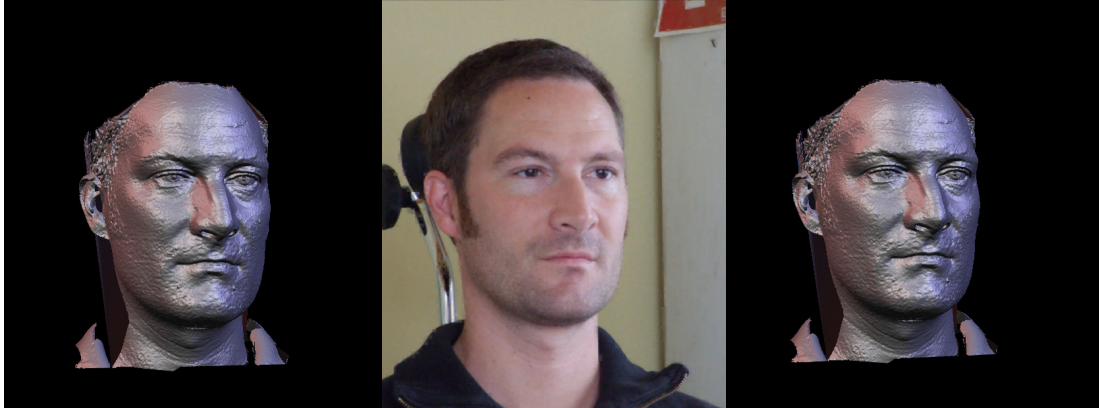
Abb. 2: Dargestellt sind eine manuelle (links) und eine computergestützte (rechts) 3-D-Modellausrichtung anhand einer 20°-Seitenaufnahme (Mitte) als Referenz. Weniger deutlich als in der vorherigen Abbildung zeigt sich auch hier ein (marginaler) Größenunterschied zwischen Fotografie und manuell-angepasster Modellprojektion (links), der jedoch in einem nachfolgenden Arbeitsschritt per Skalierung noch ausgeglichen wird (siehe Kapitel 3.2.5).
