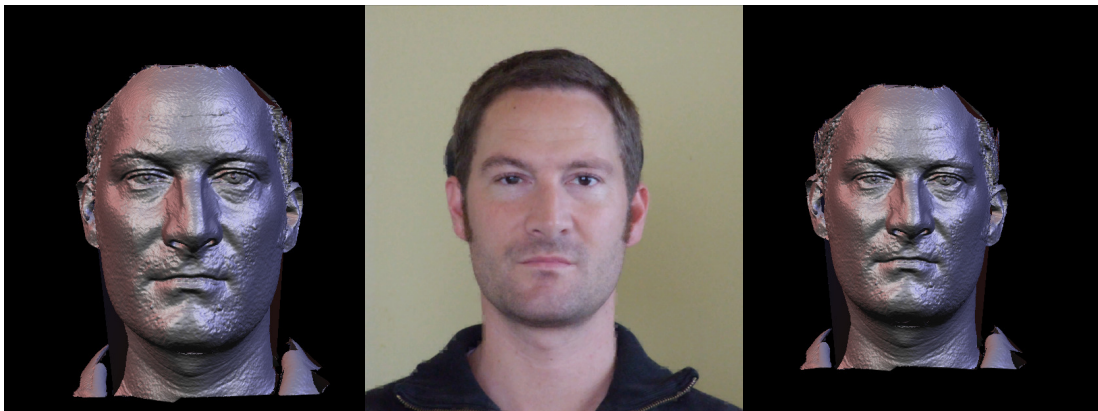
Abb.1: Anhand der in der Mitte dargestellten Frontalfotografie wird das 3-D-Modell zum einen manuell (links) und zum anderen computergestützt (rechts) ausgerichtet. Es ist erkennbar, dass sich die manuell-angepasste Modellansicht (links) hinsichtlich der Größe gegenüber der Referenzfotografie unterscheidet. Zum nachfolgenden metrischen Vergleich (Bildanalyse) zwischen den Abbildungen wird daher in einem nächsten Schritt zusätzlich eine Skalierung zur Größenanpassung vorgenommen (siehe Kapitel 2.3.5.).
