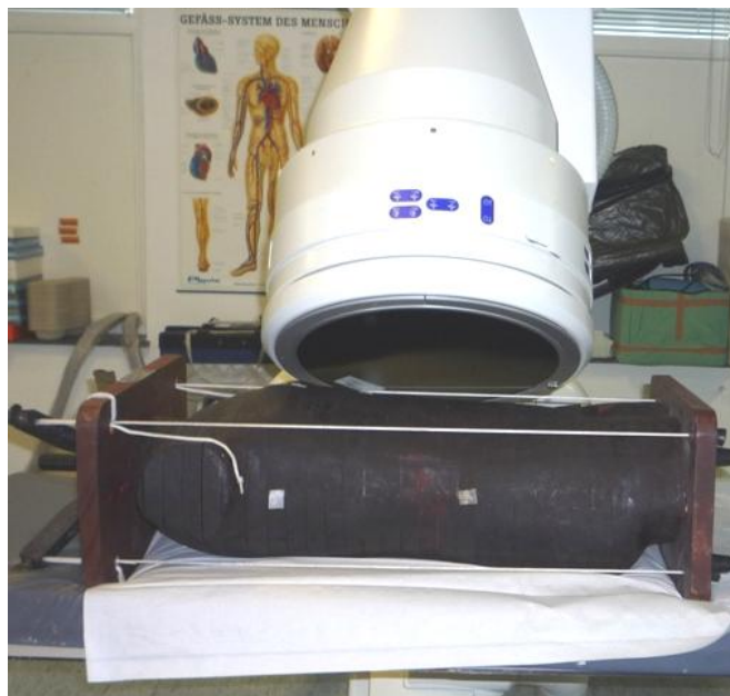
Abbildung 8: Lagerung des Aldersonphantoms für die Rotationsangiographie.
