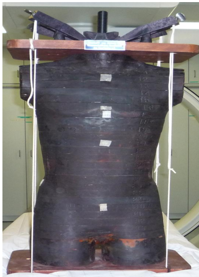
Abbildung 7: Das für die Dosimetrie eingesetzte Alderson-Rando® -Phantom.
