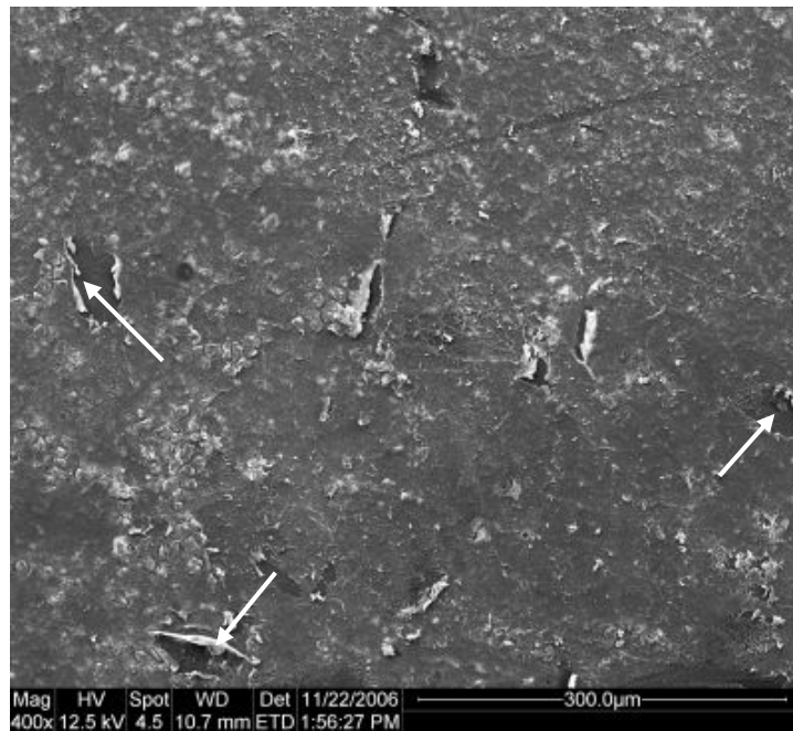
Abb. 8, 24 h-Biofilmbildung auf beschichtetem Zahnschmelz. Beschichtung ohne Fluorsilanzusatz. Die Prüfkörperoberfläche ist mit einem dichten bakteriellen Biofilm bedeckt, allerdings zeigen sich einige kleinere Areale, in denen eine teilweise Ablösung des Biofilms vorliegt, so dass die Beschichtungsoberfläche sichtbar ist (Pfeile). Vergrößerung: 400fach
