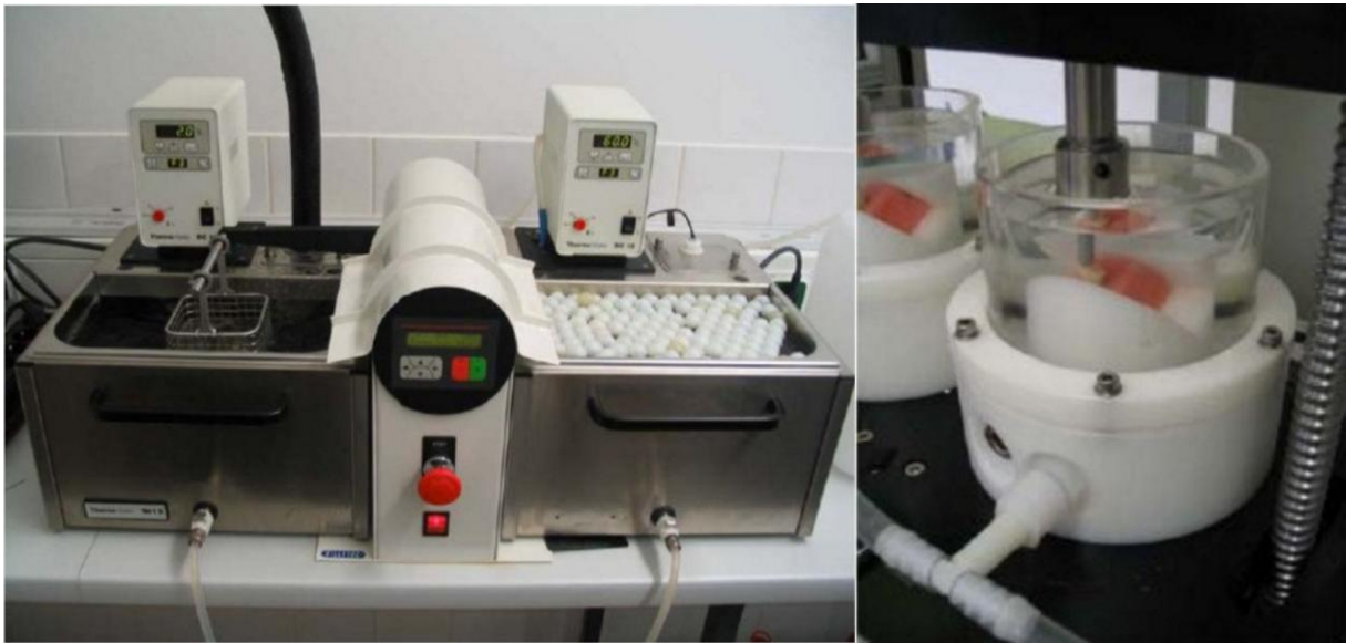
Abbildung 29: Thermozyklierer WI5 (links) und geflutete Einzelkammer mit eingespannter Probe im Kausimulator (rechts).
