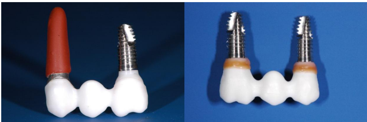
Abbildung 25: Die, in den Brücken fixierten Implantate vor dem Einbetten (links und rechts; rechts bereits mit TempoSIL und Klebewachs fixiert).
