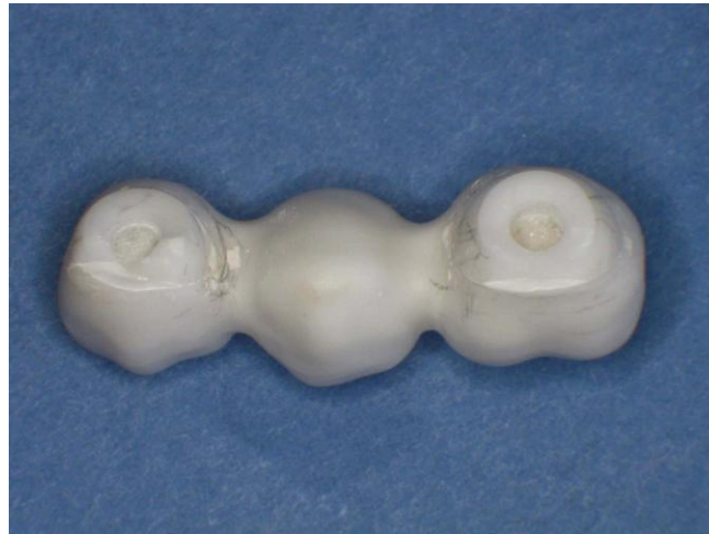
Abbildung 51: Übersicht der Brückenkonstruktion der Probe I3: Implantat-Implantat + nicht individualisiert + nicht gealtert.
