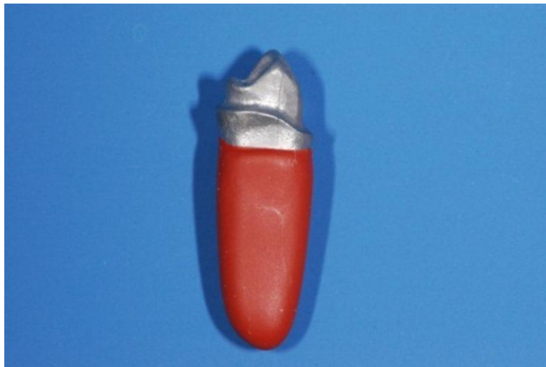
Abbildung 21: Mit Anti-Rutsch-Lack ummantelter CoCrMo-Zahn zur Herstellung eines künstlichen Parodontiums.
