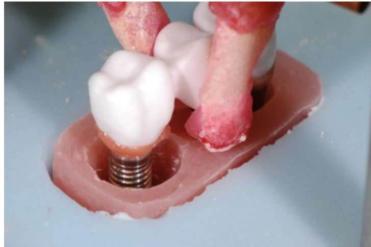
Abbildung 26: Einbringen der, in der Halterung fixierten Brücken beziehungsweise Implantate in die Hohlform. Die Aussparungen der Hohlform wurden anschließend mit Kunststoff (PMMA) aufgefüllt.
