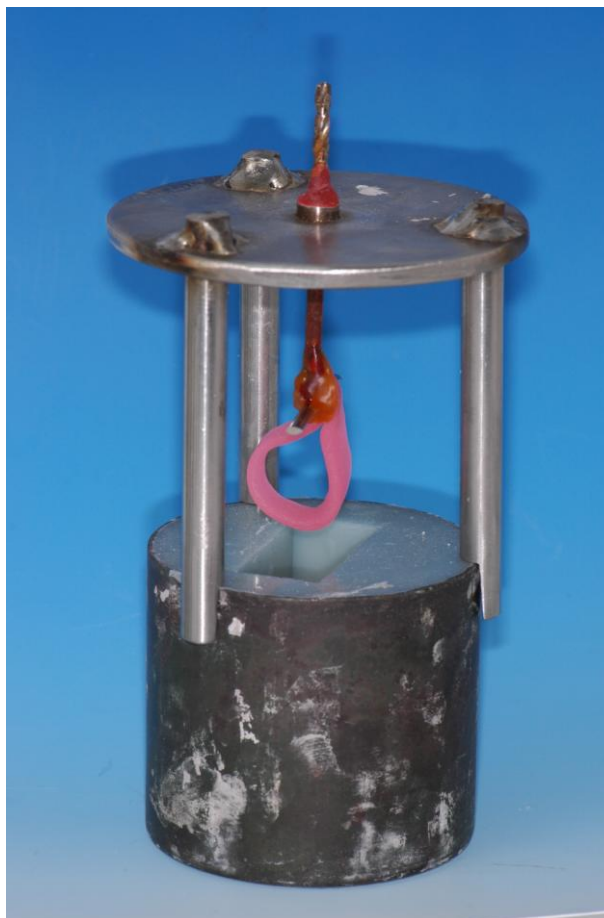
Abbildung 24: Übersichtsaufnahme der Einbett-Halterung.
