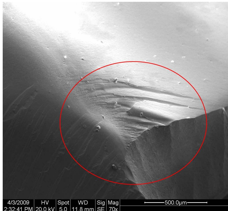
Abbildung 50: Ausschnittvergrößerung der Absplitterung okklusal (rote Markierung).
