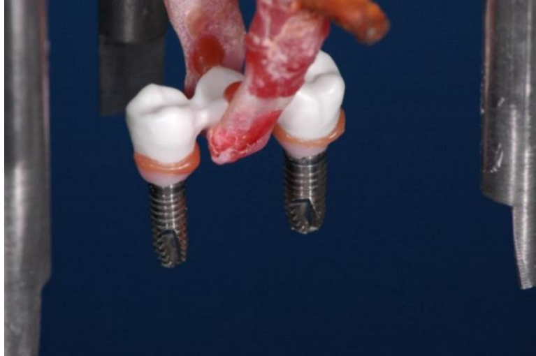
Abbildung 23: Fixierung der Brücken in der Halterung vor dem Einbetten in Kunststoff (PMMA).
