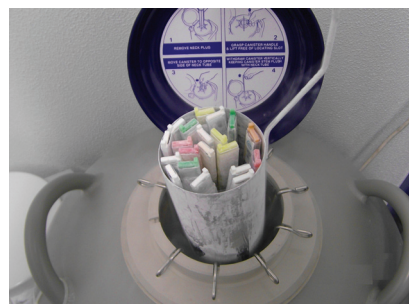
Abbildung 24: Aufbewahrung der Kassetten in Köchern im Dewar-Gefäß mit flüssigem Stickstoff
