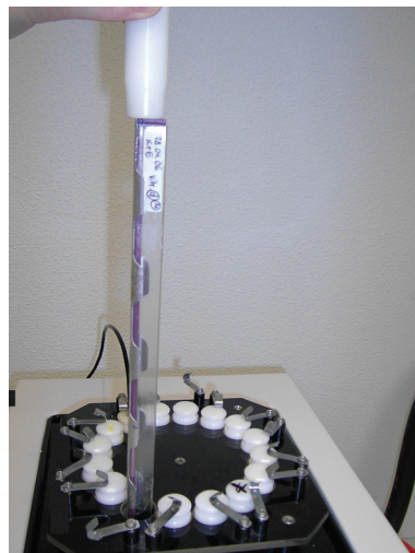
Abbildung 21: Einfriervorgang: Haltevorrichtung für die Kassetten
