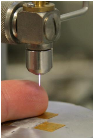
Abbildung 1: Am Leibniz Institut für Oberflächenmodifizierung in Leipzig entwickelte miniaturisierte Plasmaquelle. Der Plasmajet (Plasmastrahl) besitzt eine Temperatur von weniger als 40 °C.
