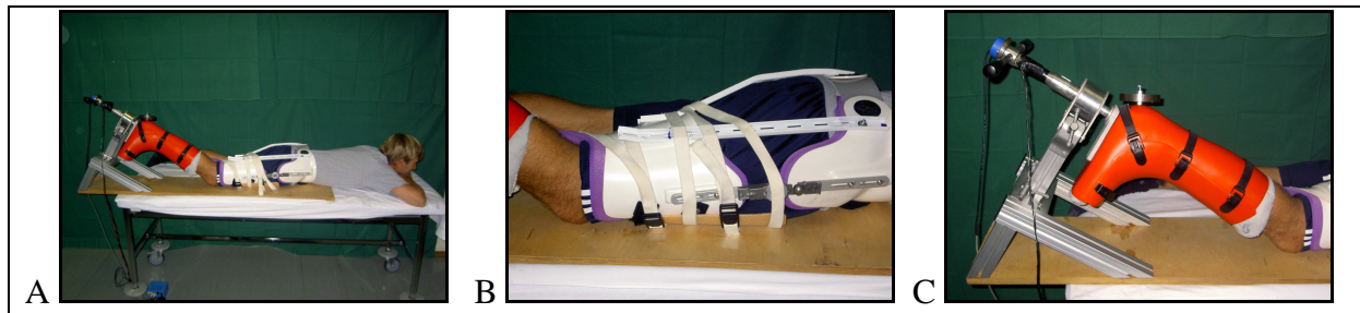
Abb.11 A-C: Untersuchungsaufbau: A: Proband mit Newport-Orthese auf Untersuchungsliege B: Oberschenkelfixierung C: Schuh im Gerät eingespannt, Neutralposition, 30° Knieflexion
