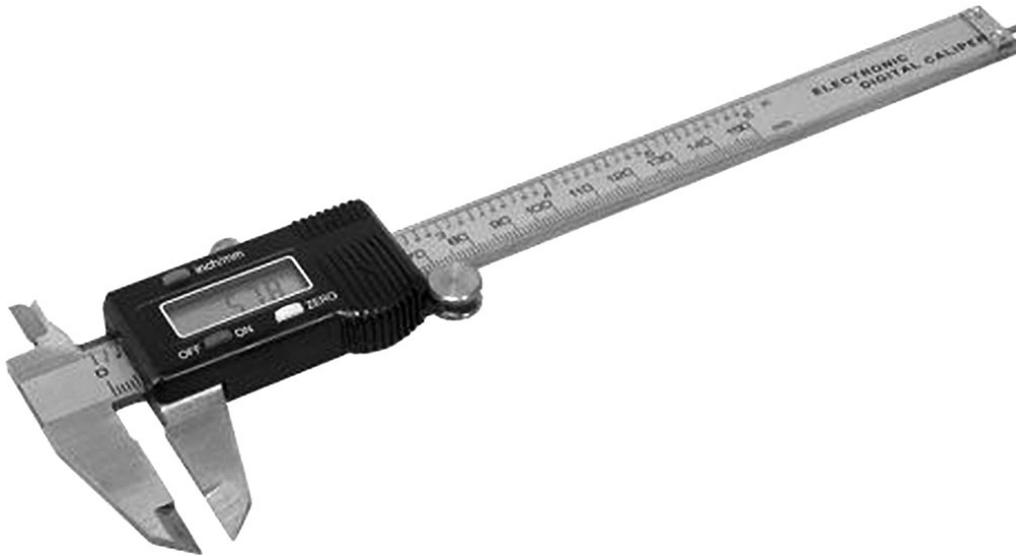
**Abbildung 17:** Digitale Schieblehre zur Vermessung der Abformmodelle (eigene Aufnahme).
