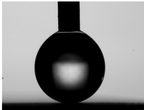
Abbildung 3.21.: Kontaktwinkelmessung an einer Oberfläche, die mittels chemischer Gasphasenabscheidung des Precursors [\text{H}_2\text{AlO}^t\text{Bu}]_2 auf einem Siliziumsubstrat erzeugt wurde ( T_{\text{Substrat}} \leq 600^\circ\text{C} , T_{\text{Precursor}} \geq 0^\circ\text{C} , Abscheidedauer=30 min: Wassertropfen nach dem Aufbringen auf die Oberfläche mittels einer Kanüle
