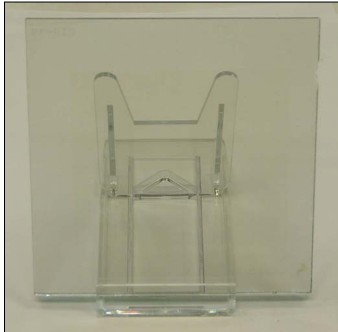
Bild 82: Testdruck unter Verwendung von DEGMBE+HPC (100g : 9g) auf einem K-Glassubstrat (Druckfläche 9x9 cm 2 ). Deutlich ist zu erkennen, dass die Druckpaste bei der Ausheiztemperatur von 240 °C kaum noch sichtbare Rückstände auf dem Substrat hinterlässt.
