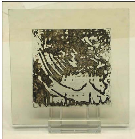
Bild 80: Testdruck unter Verwendung von Glycerin auf einem Glassubstrat (Druckfläche 9x9 cm 2 ). Deutlich ist zu erkennen, dass das Glycerin bei der Ausheiztemperatur von 240 °C Rückstände auf dem Substrat hinterlässt und nicht für eine Verwendung als Pastenbestandteil geeignet ist.
