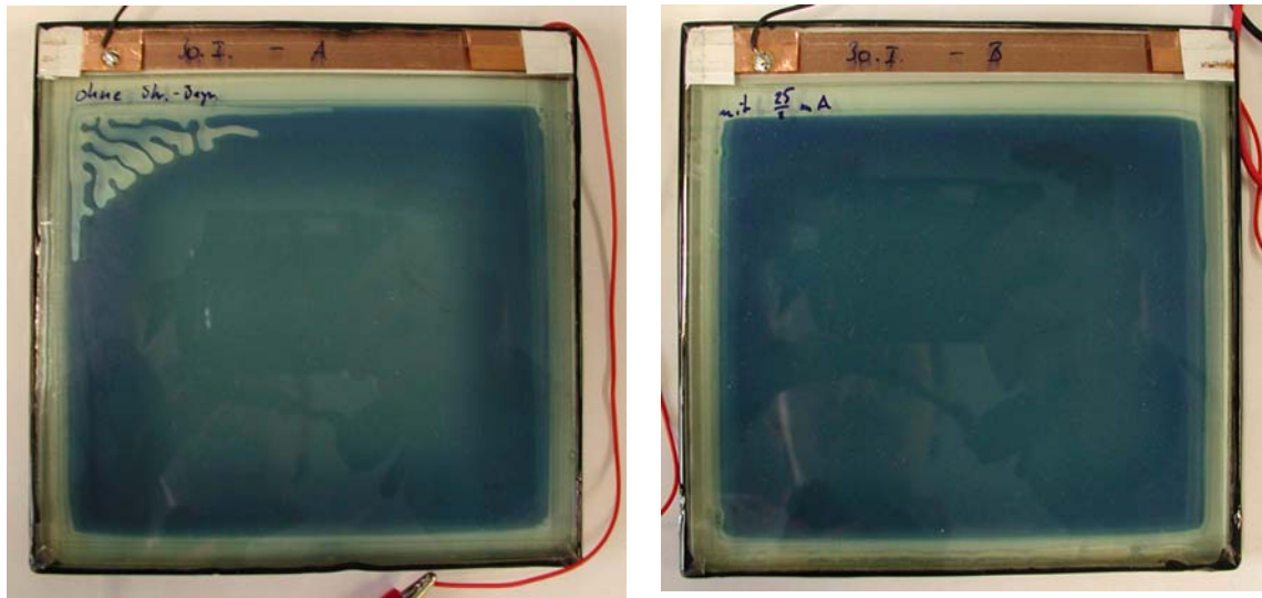
Bild 139: Testzellen bei potentiostatischer (links) und galvanostatischer (rechts) Ansteuerung im gefärbten Zustand nach 12000 Schaltzyklen.
