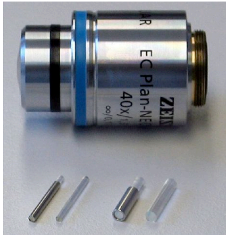
Abb. 2.6: GRIN-Linsen im Größenvergleich mit einem Standard-Mikroskop-Objektiv
