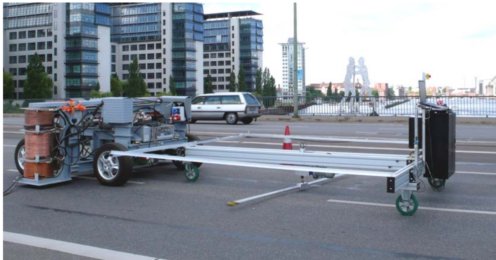
Abb. 5.11: Mobiles Messsystem zur Spanndrahtbruchortung in Querspanngliedern von Brückenplatten ( TU Berlin )
