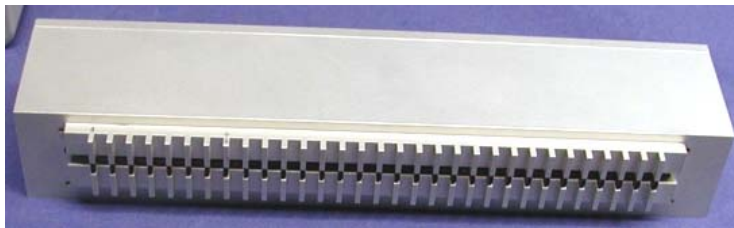
Abb. 4.4: Hallsondenzeile zur Prüfung von Verzahnungen
