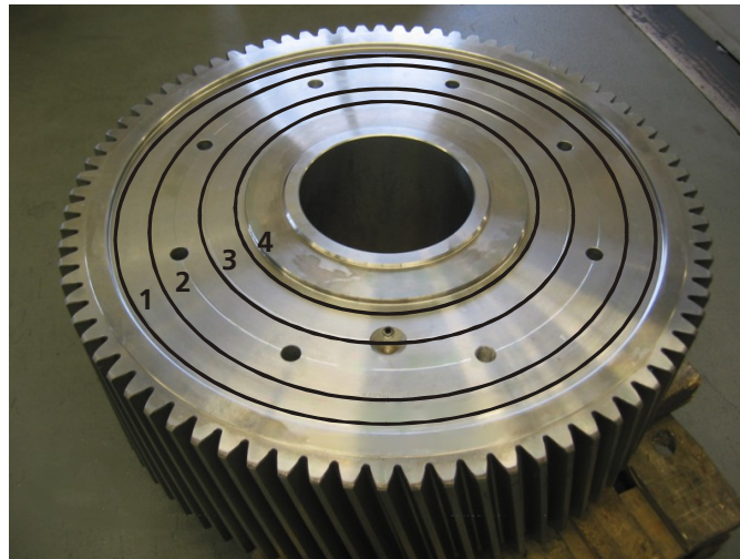
Bild 6.9: Stirnrad mit den schwarz eingezeichneten Messspuren 1 - 4.
