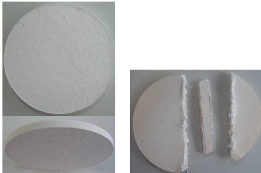
Abbildung 56: Proben mit runder Pressmatrix bei 100 kN gefertigt
