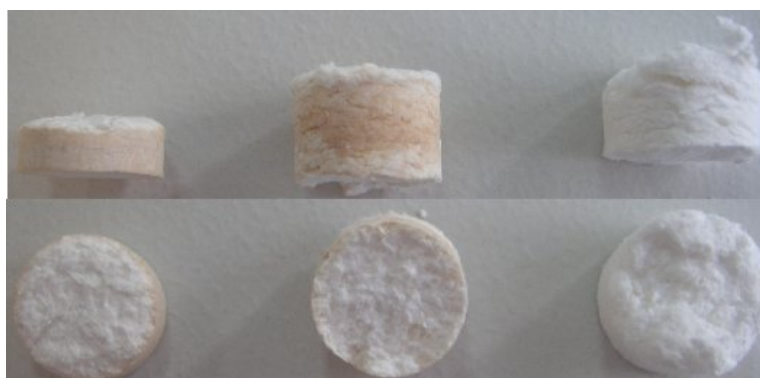
Abbildung 55: Proben mit Einsatzverhältnis n_{\text{Säure}}:n_{\text{Cellulose}} 0,5:1 , 0,1:1 und 0:1(v.l. n.r.). Links Probe mit Skalpell geschnitten; mitte: Probe gebrochen; rechts: probe Watteähnlich zerfast
