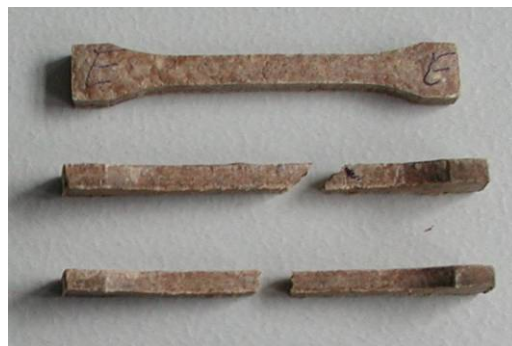
Abbildung 63: Zugstäbe vor (oben) und nach dem Zugversuch (unten)
