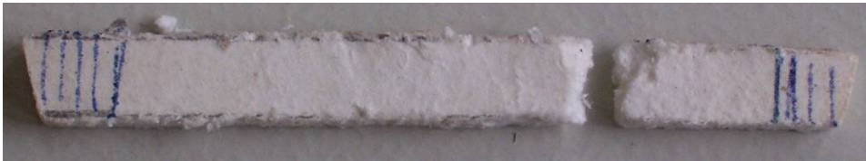
Abbildung 60: Probenkörper nach dem Zugversuch (markiert Fläche Spannbacken)
