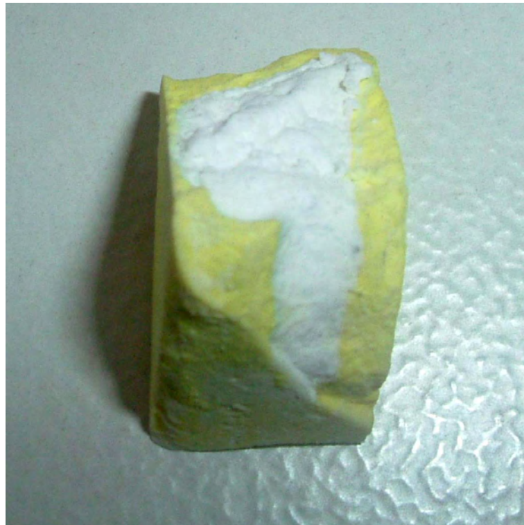
Abb. 4.42: SE15-Grünkörper getränkt mit Natriumwolframat mit anschließender chemischer Fällung von Wolframtrioxid, a) nach dem Trocknen, b) nach dem Kalzinieren unter Wasserstoffatmosphäre bei 1200 °C
