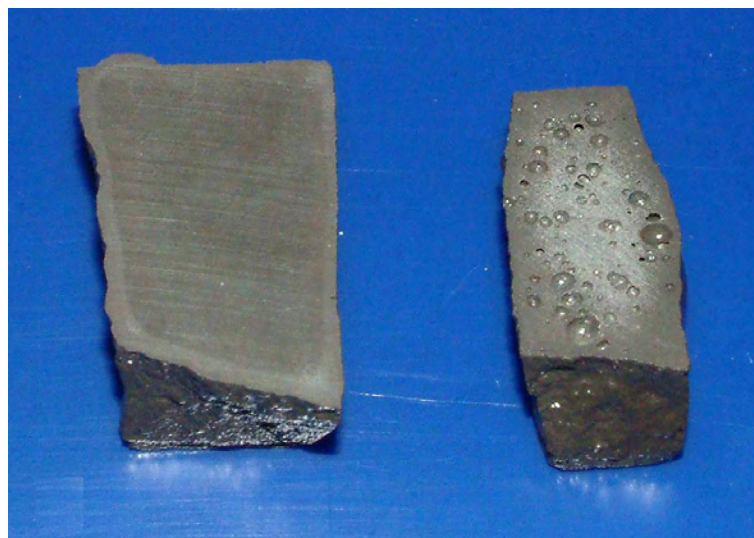
Abb. 4.52: Zwei mit Ammoniumwolframat getränkte und an Luft getrocknete Proben nachdem sie unter Wasserstoff reduziert und anschließend bei 1650 °C gesintert wurden, links ohne Methylzellulose, rechts mit Methylzellulose
