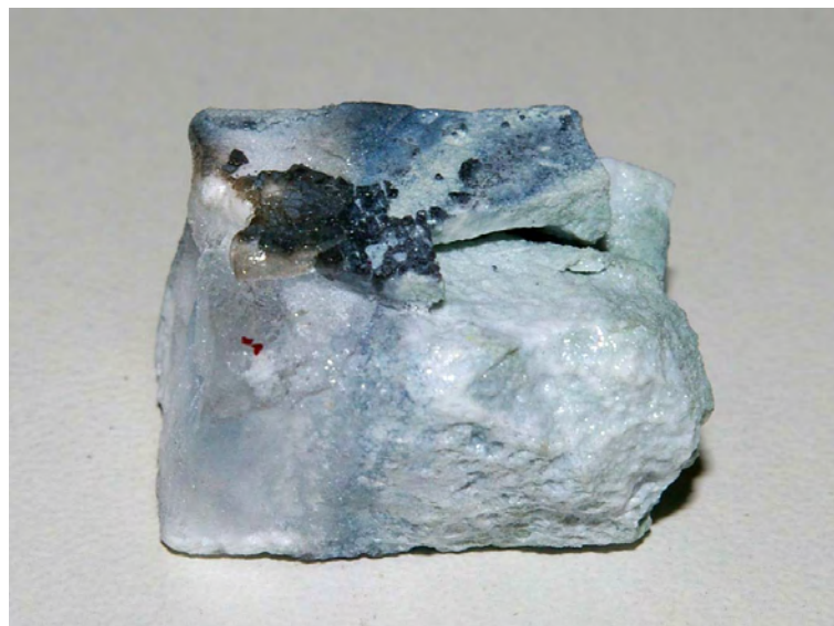
Abb. 4.51: Aufnahme einer mit Natriumwolframat getränkten Probe, die bei 1650 °C dichtgesintert wurde
