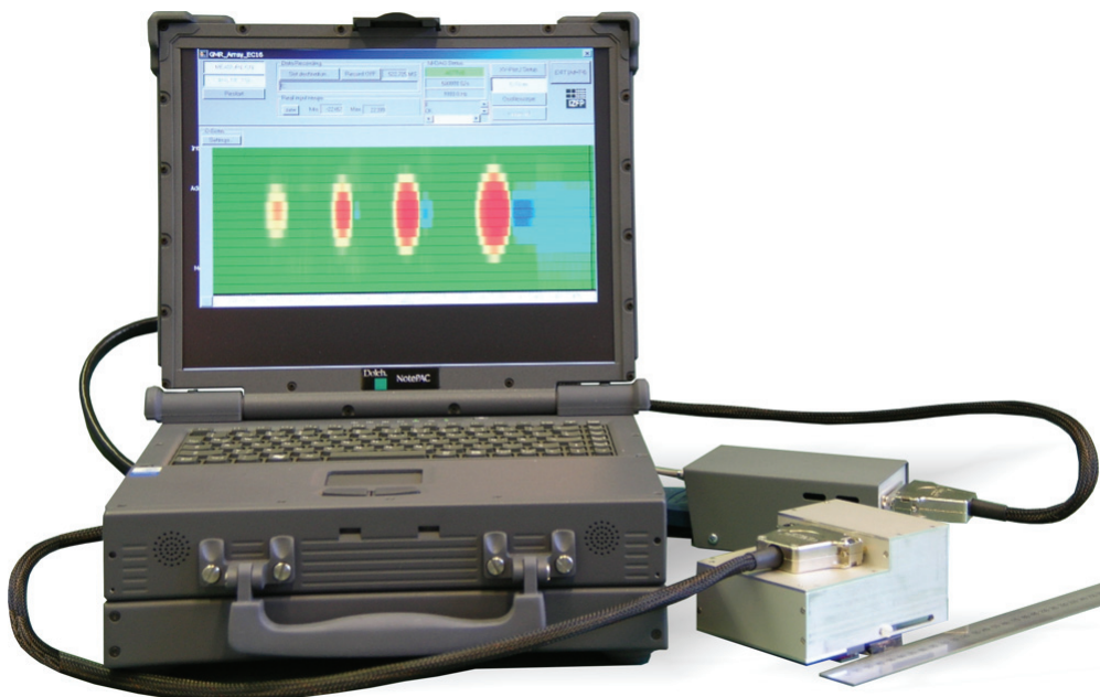
Abbildung 6.13: Gesamtprüfgerät mit WS-GMR-Array (Foto).
