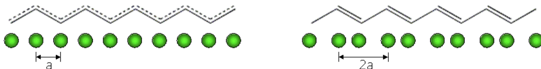
Abb. 1.11: Elektronensystem von Polyacetylen ( a : mittlerer Atomabstand); links : delokalisiert; rechts : alternierende Einfach- und Doppelbindungen.
