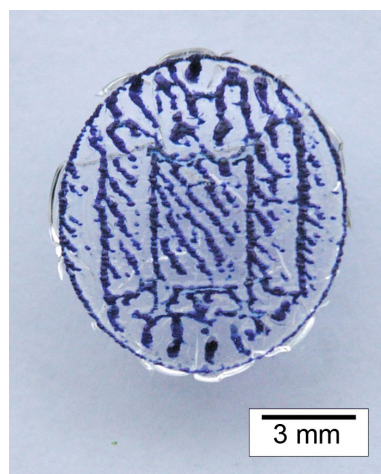
Abbildung 4.118: Makroaufnahme einer direkt ins Farbpulver eingelaserter Eule nach Entfernung des ungesinterten Farbpulvers
