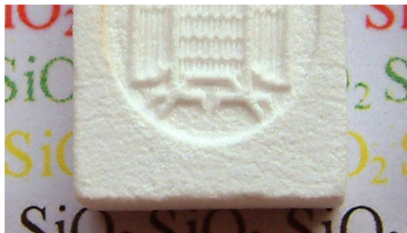
Abbildung 4.24: Detailvergrößerung: Strukturierter Grünkörper ohne resublimiertes Material
