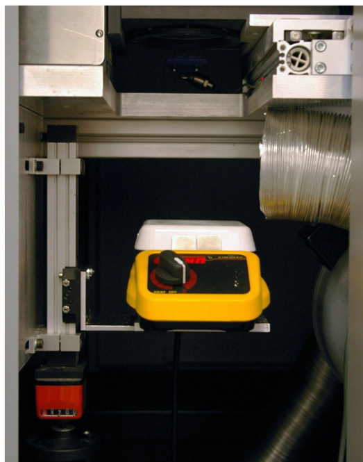
Abbildung 3.4: Heizplatte zur Reduzierung der thermischen Spannungen
