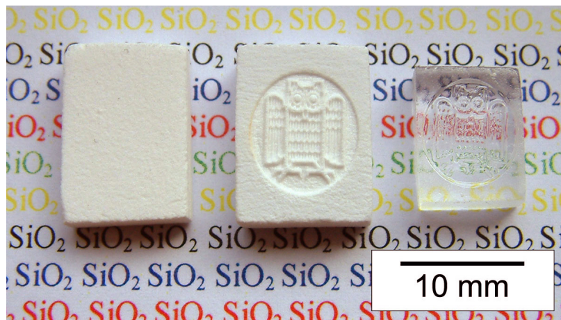
Abbildung 4.23: Prozessschritte: Grünkörper, strukturierter Grünkörper und gesinterter Glaskörper für eine 8 mm × 12 mm große laserstrukturierte Probe
