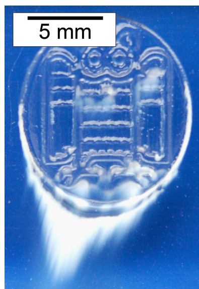
Abbildung 4.37: Resublimationsartefakte bei einer in BSG ablatierten Eule
