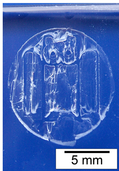
Abbildung 4.36: Eigenspannungsinduzierte Risse bei einer in BSG abladierten Eule
