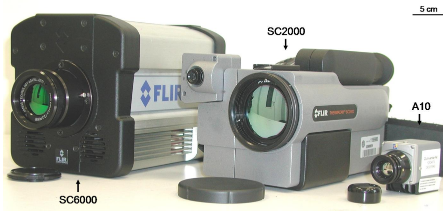
Abbildung 5.20: Infrarotkameras der Firma Flir Systems AB links - gekühlte Halbleiterkamera ThermaVision™ SC6000 HS (InSb) mitte - ungekühlte Bolometerkamera üblicher Baugröße ThermaCAM™ SC2000 rechts - miniaturisierte Bolometerkamera ThermaVision™ A10
