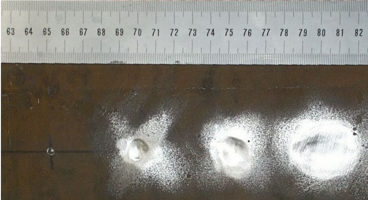
Abbildung 11.8 kalottenförmige Außentestfehler; Tiefe 5%, Durchmesser 10, 15 und 30 mm
