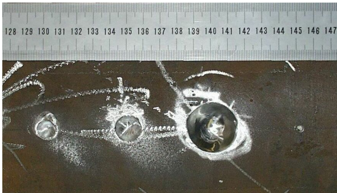
Abbildung 11.12 kalottenförmige Außentestfehler; Tiefe 70%, Durchmesser 10, 15 und 30 mm
