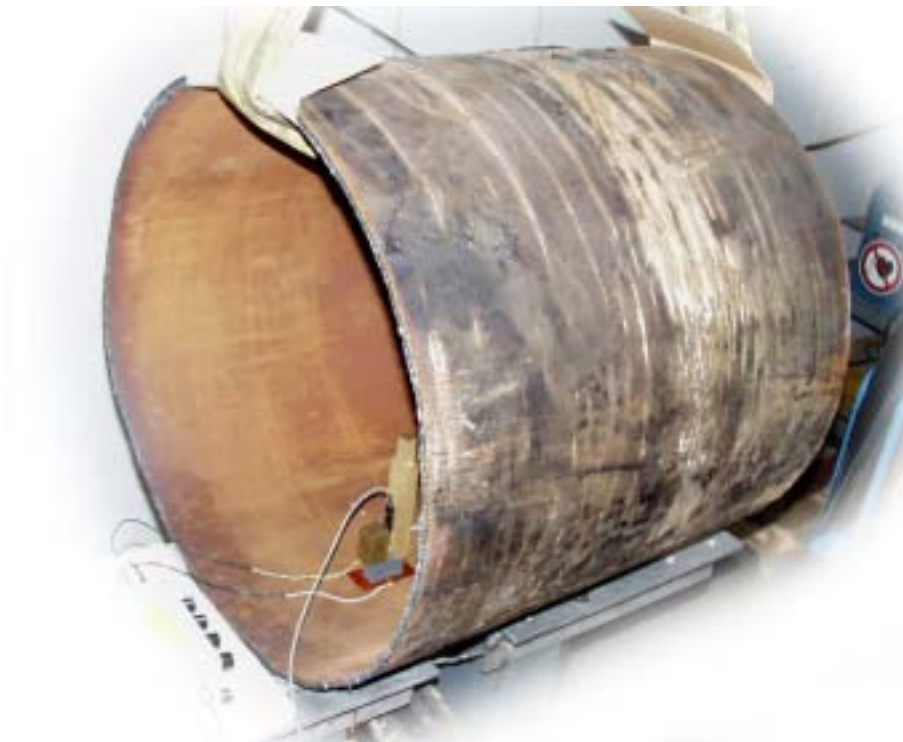
Abbildung 11.19 Rohr z. T. beschichtet, Wanddicke 10 mm; Länge 730 mm; Durchmesser 760 mm
