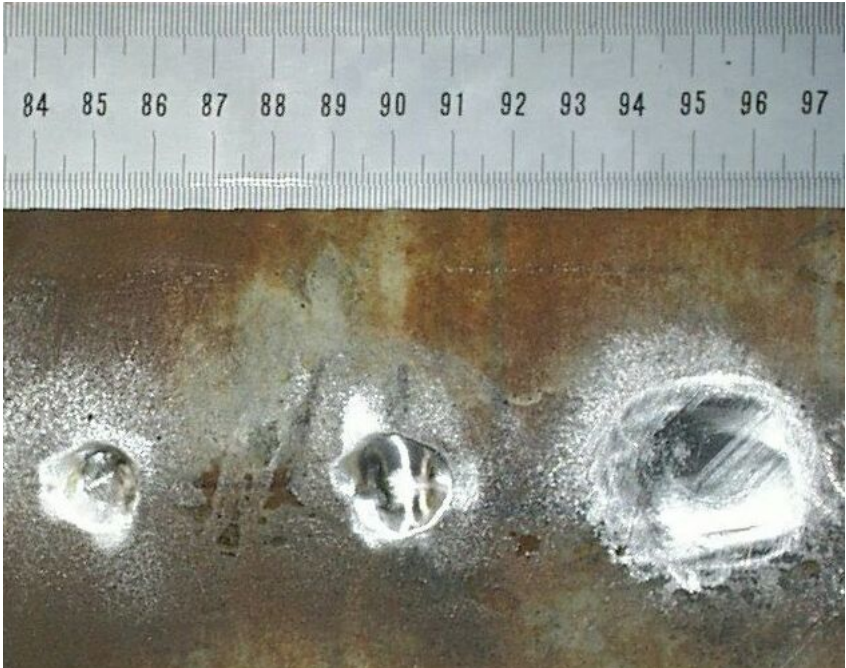
Abbildung 11.9 kalottenförmige Außentestfehler; Tiefe 15%, Durchmesser 10, 15 und 30 mm
