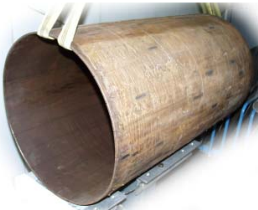
Abbildung 11.20 Rohr mit Delaminationen (#6), Wanddicke 8 mm; Länge 1135 mm; Durchmesser 655 mm
