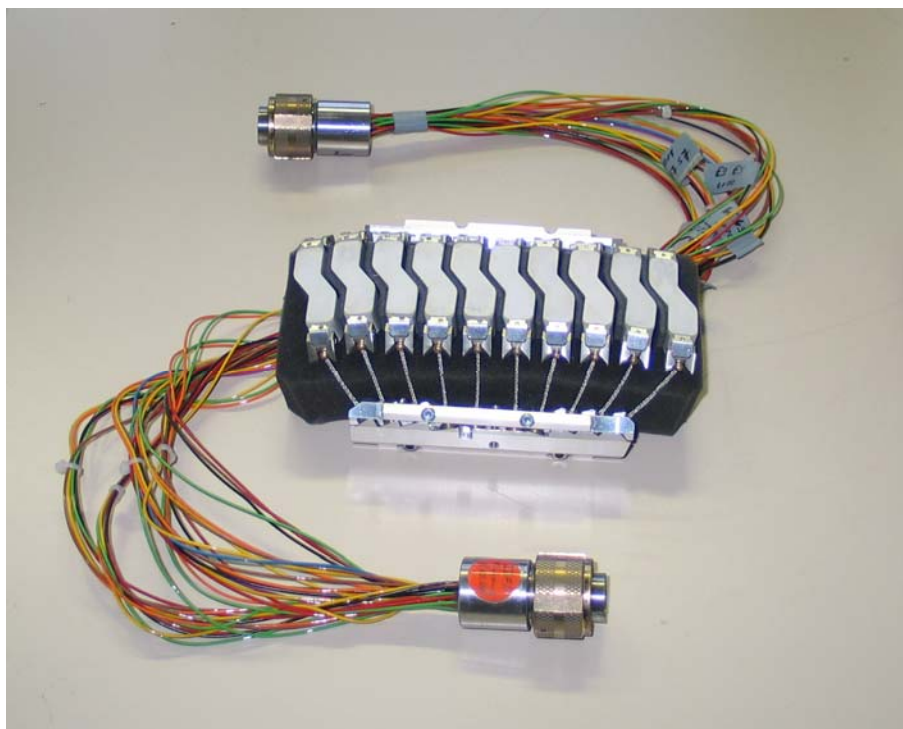
Abbildung 8.2 20-kanaliges Sensorarray: 10 Sensorkufen mit Verschleißschutz aus monolithischer Al 2 O 3 -Keramik bilden mit einer Aufhängungseinheit ein Array.
