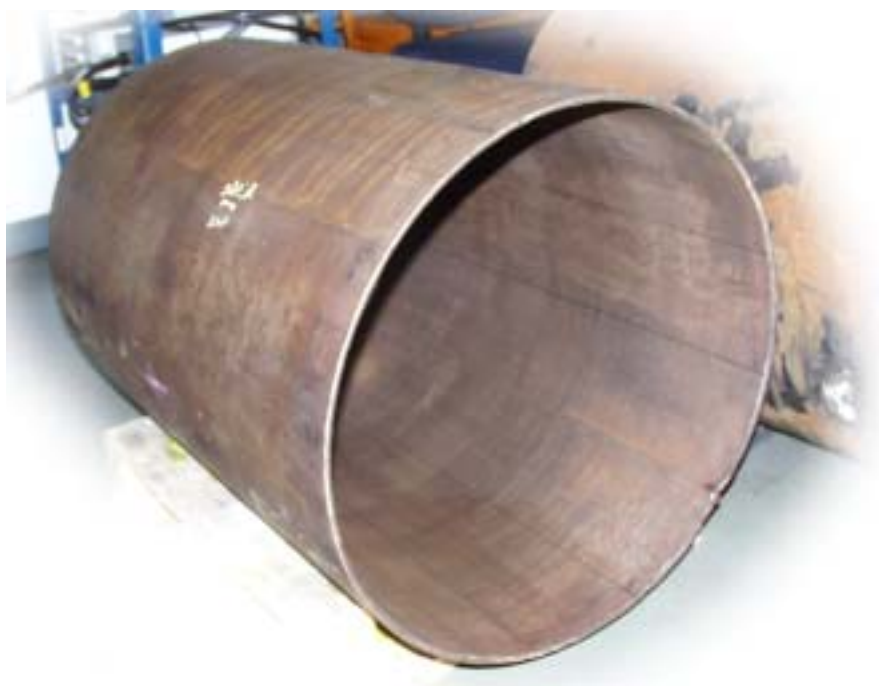
Abbildung 11.21 Rohr mit Delaminationen (km 19,036), Wanddicke 8 mm; Länge 885 mm; Durchmesser 660 mm
