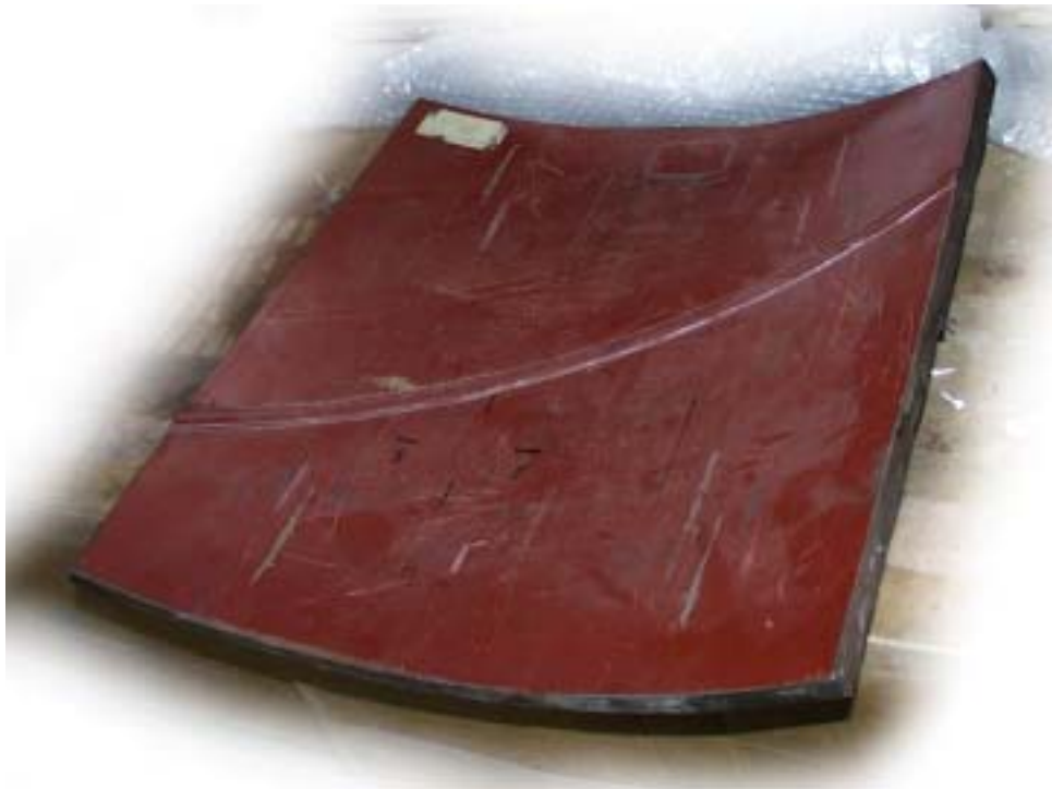
Abbildung 11.16 Rohrsegment, 16 mm Wanddicke, mit Spiralnaht, außen zum Teil beschichtet
