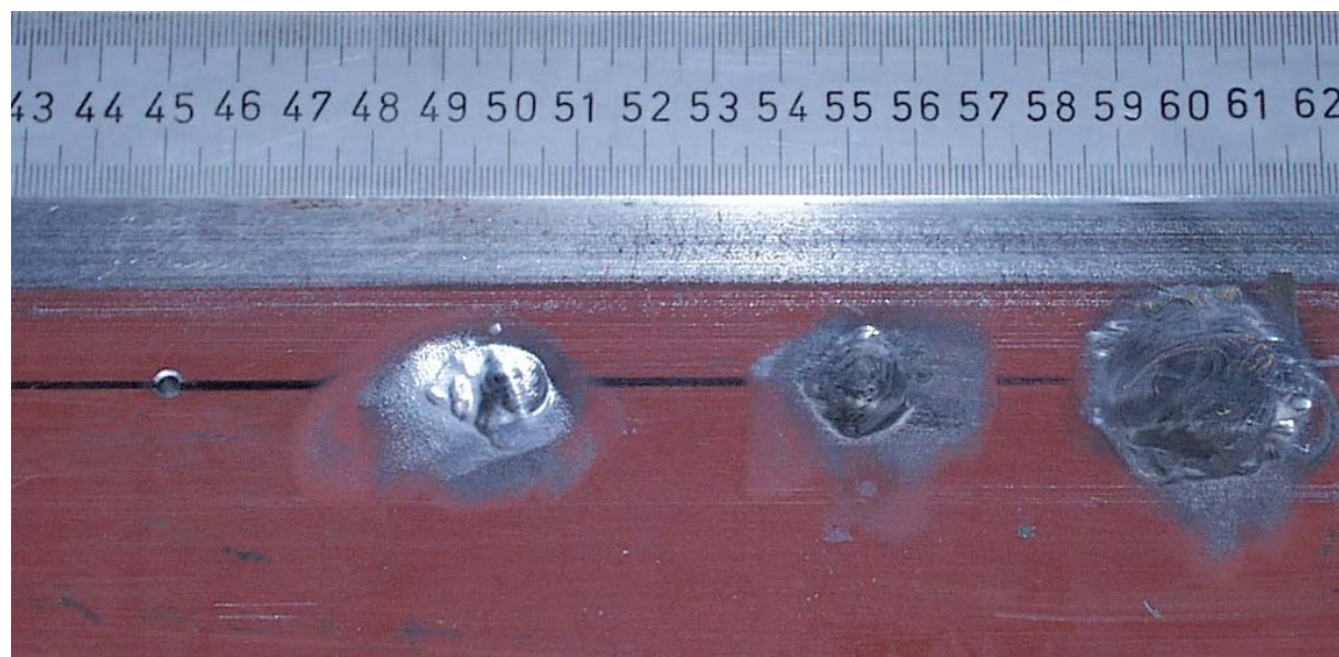
Abbildung 11.13 kalottenförmige Innentestfehler; Tiefe 5%, Durchmesser 10, 15 und 30 mm
