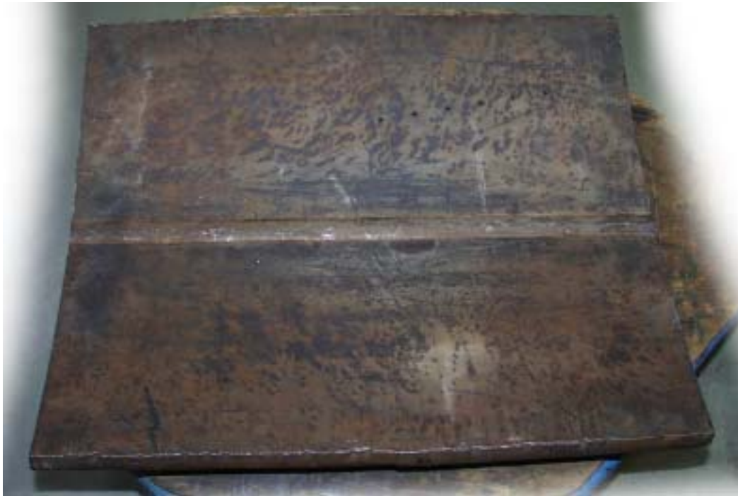
Abbildung 11.18 Mannesmann Rohrsegment mit Längsnaht, Wanddicke 16 mm
