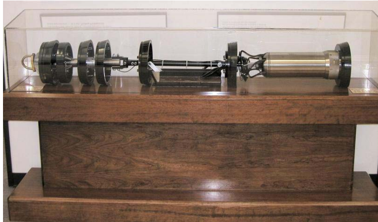
Abbildung 2.2 erster Streuflussmolch - Tuboscope Pipeline Services (Quelle: O.-A. Barbian)
