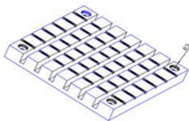
Abbildung 2-15. Probenhalter aus POM für die Alterung von Keilproben
