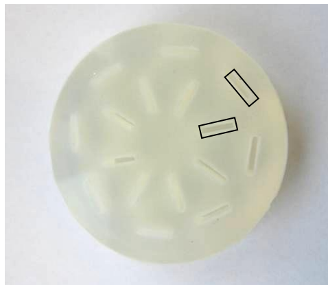
Abbildung 2-3. Silikonform zum Abguss von EP auf Metall-Substrate oder PTFE
