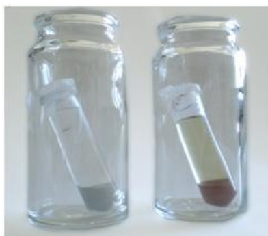
Abbildung 5-6. Fotos von Metall-modifiziertem DETA nach 30 min Kontakt mit Al-Pulver (links) oder mit Cu-Pulver (rechts)
