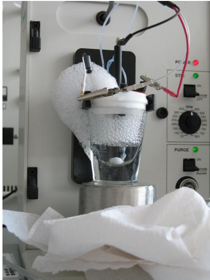
Abbildung 73: Aufnahme der Messzelle mit Proteinlösung (BSA) beim Spülen mit N_2 .
