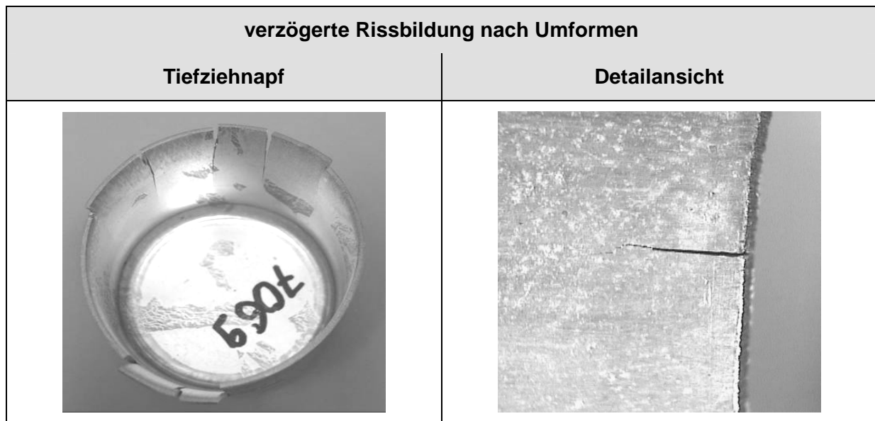
Abbildung 2.27: Verzögerte Rissbildung nach Umformen an einem Tiefziehnapf aus X-IP1000® (TWIP-Stahl) mit Blechdicke=1mm, \varnothing -Ronde=100mm und \beta=2 nach Auslagerung an Standard-Atmosphäre (Luft). Links: Gesamtansicht, rechts: Detailansicht.
