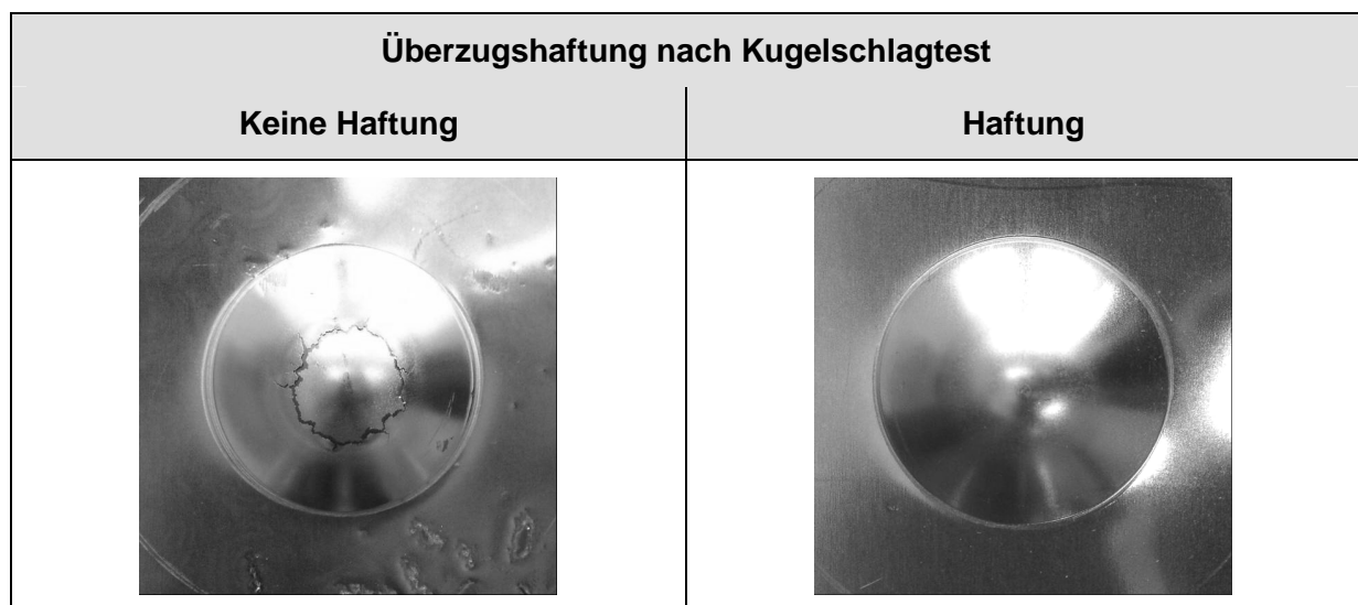
Abbildung 4.6: Ergebnisbeispiele für die Überzugshaftung anhand Kugelschlagtest. Links: keine Haftung, Rechts: Haftung gegeben
