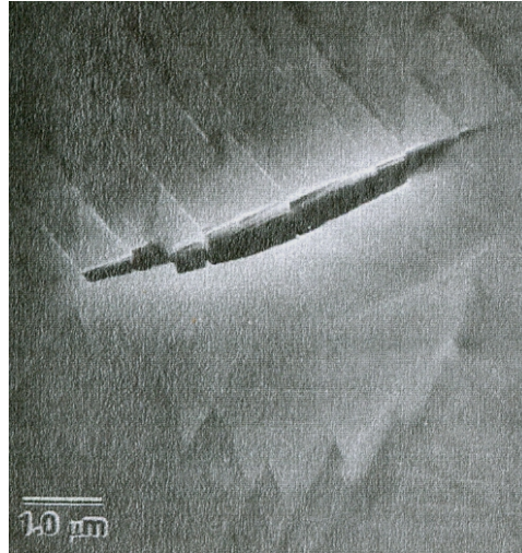
Abbildung 2.26: Aufgerissene Zwillingsgrenze mit Gleitbändern in meta-stabilem CrNi-Stahl anhand REM-Aufnahme /126/
