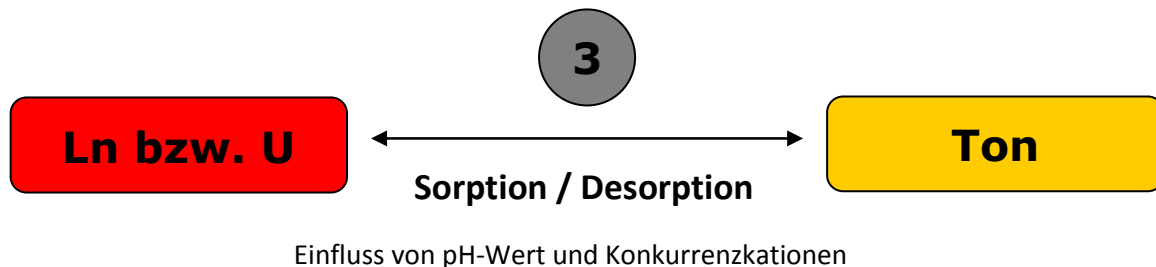
Abb. 64: Binäres System aus Metall-Ionen und Ton, Einfluss von pH-Wert und Konkurrenzkationen auf Sorption und Desorption
