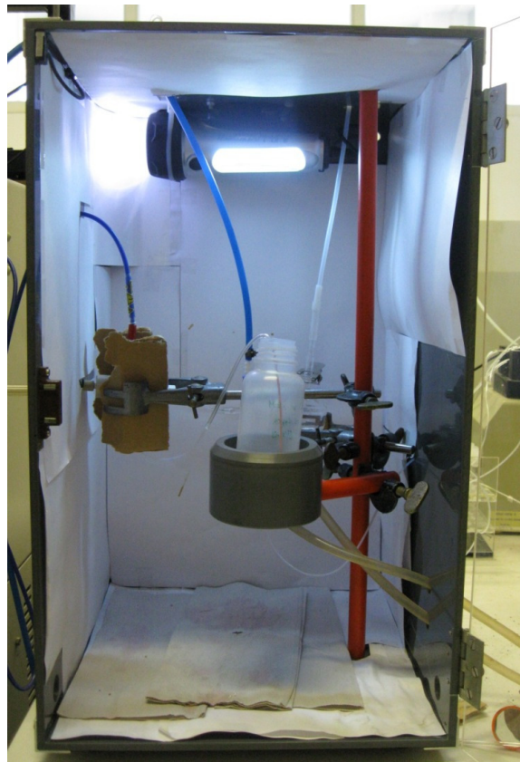
Abb. 32: Das entwickelte Interface zwischen CE und ICP-MS
