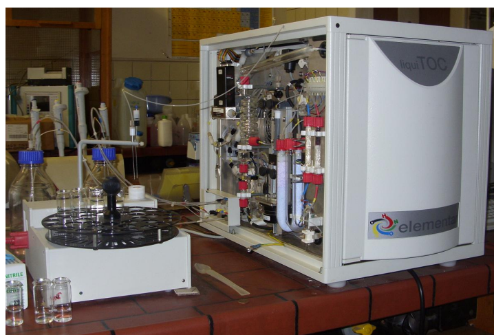
Abb. 37: Das verwendete Gerät Liqui-TOC mit Probensamplers
