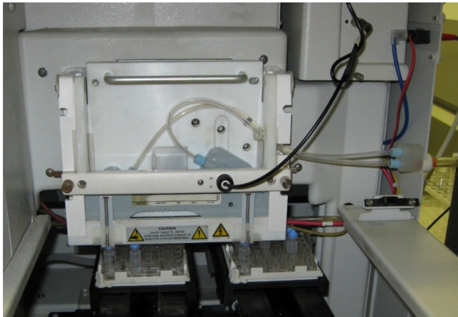
Abb. 31: Modifizierte Cartridge in der CE-Apparatur mit heraus geführter Kapillare
