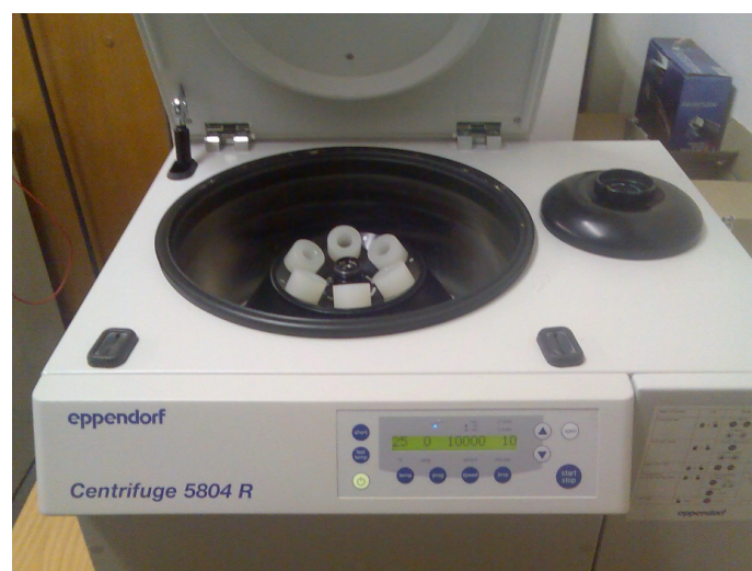
Abb. 40: Zentrifuge „Centrifuge 5804 R“ der Firma Eppendorf
