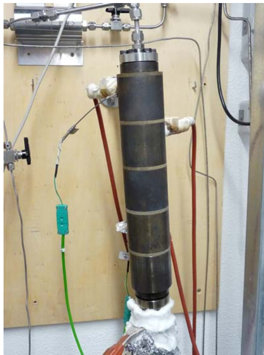
Abbildung 2.5: Strömungsrohrreaktor für konventionelle Katalysatorrestungen.
