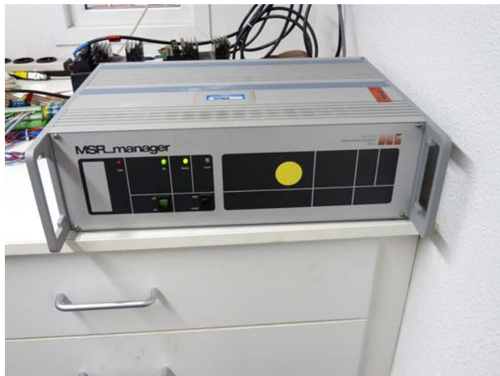
Abbildung 2.4: MSR_Manager für die Reaktorsteuerung (HiTec Zang).
