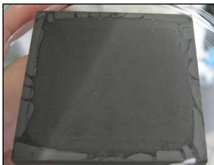
Abbildung 89: Spin-coating-Film von TEOS/NAD + -GPS/DI/DSDH/PEI bei 1000 RPM nach dem Experiment in der Durchflusszelle.
