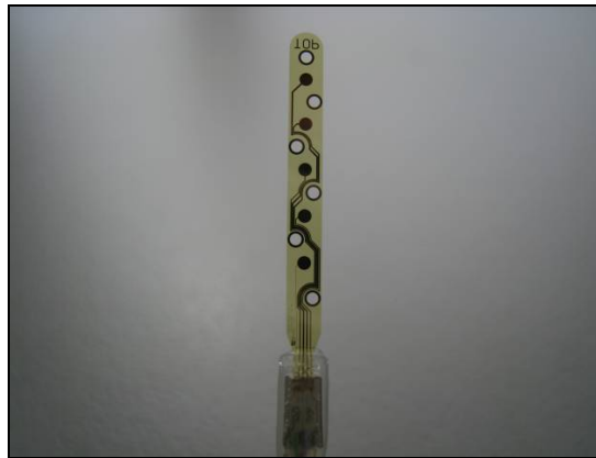
Abbildung 117: Vergrößerung der Elektrodenköpfe mit fünf Kontaktstellen.
