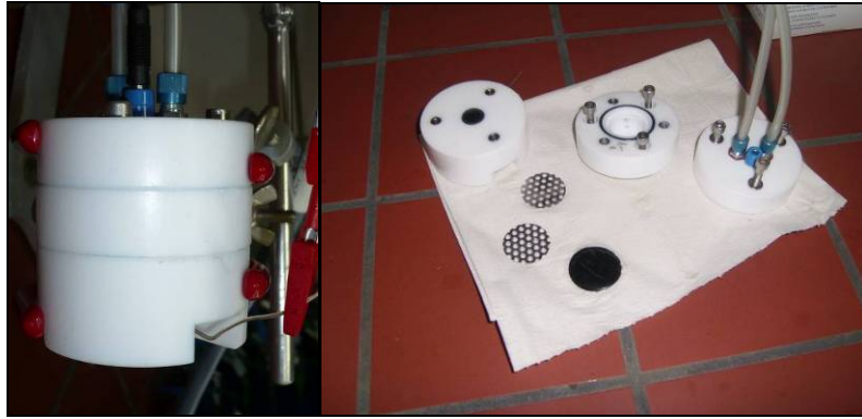
Abbildung 63: Zusammengebaute und zerlegte Batchzelle.
