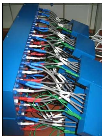
Abbildung 159: Mit den zwei 8fach-Potentiostaten verbundenen 16 Niederstrommessfunktionen.
