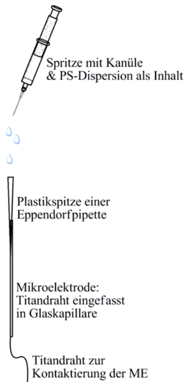
Abbildung 103: Aufbringen der PS-Dispersion auf die in eine Pipettenspitze eingebundene Mikroelektrode.
