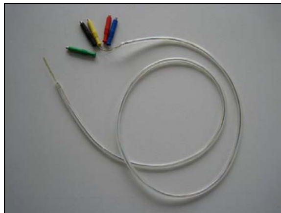
Abbildung 116: Epimysium-Mikroelektrode mit Polyimidisolierung.
