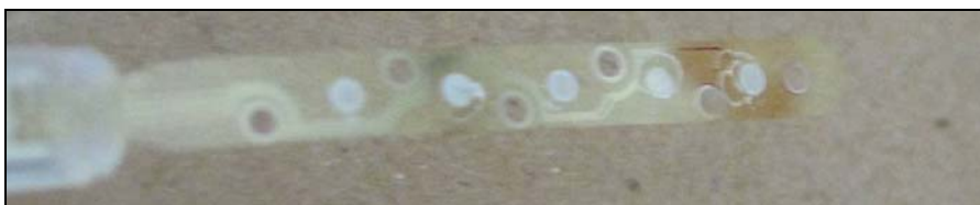
Abbildung 118: Elektrodenkopf mit endo-Templat aus PS-Partikeln auf den Kontaktstellen.
