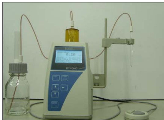
Abbildung 164: Titrator Titronic Universal der Firma Schott Instruments zur sukzessiven Glucosezugabe.
