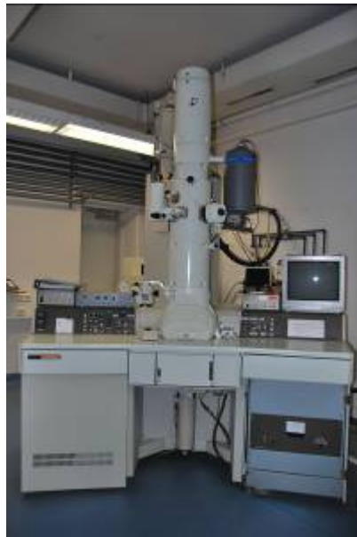
Abbildung 9.12: Bild des Jeol JEM 2010 Mikroskops mit gekoppeltem EDX Detektor Link ISIS Oxford.
