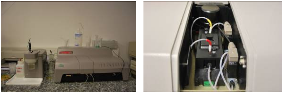
Abbildung 9.11: links: Bild des verwendeten Zetasizers; rechts: graphische Darstellung der Messzelle mit den Durchflusselektroden.
