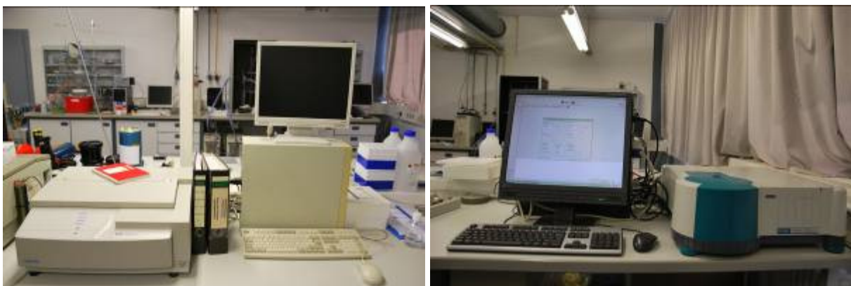
Abbildung 9.4: Graphische Darstellung der verwendeten UV / Vis-Spektrometer; links: UV / Vis-Spektrometer der Firma Unicam, rechts: der Firma Varian.
