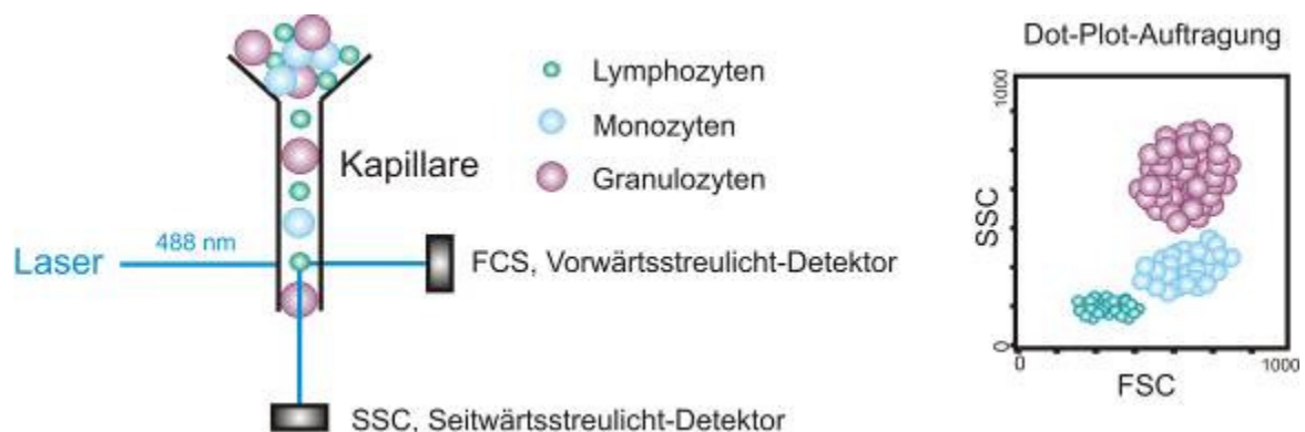
Abbildung 3.6: Schematische Darstellung des Messprinzips eines FACS-Gerätes sowie die Auftragung der Ergebnisse in der Dot-Plot-Darstellung, d. h. jeder Punkt repräsentiert eine Zelle.
