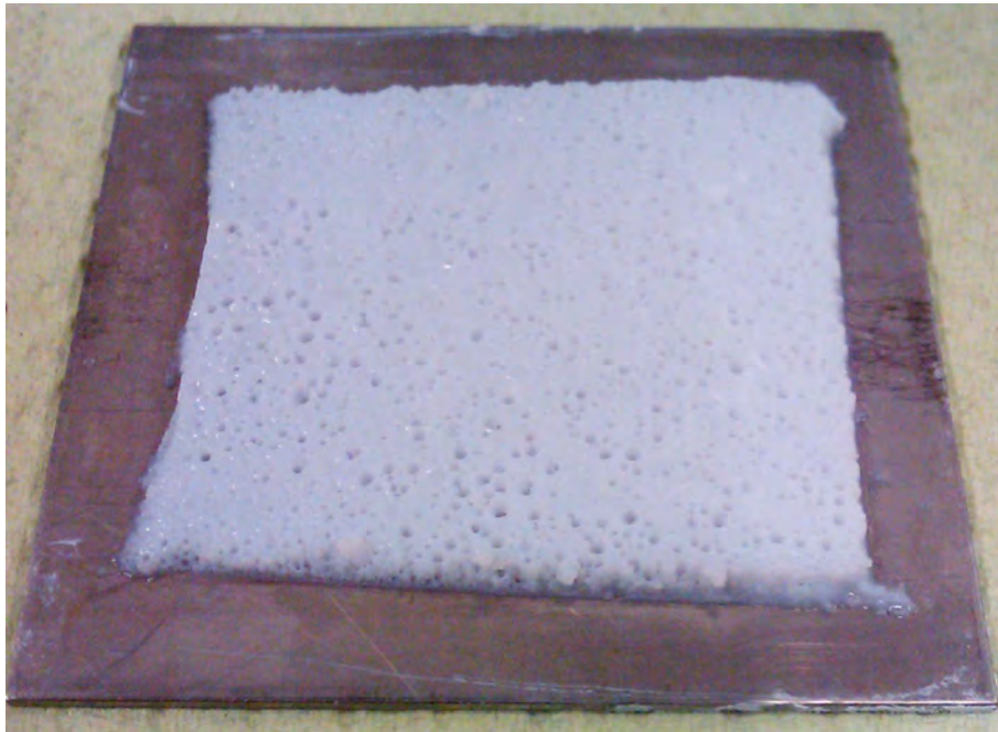
Abbildung 4.37: Poröse Abscheidung, erzielt aus OX50-Suspension mit 15 Gew.-% bei 20 V Gleichspannung innerhalb von 4 min
