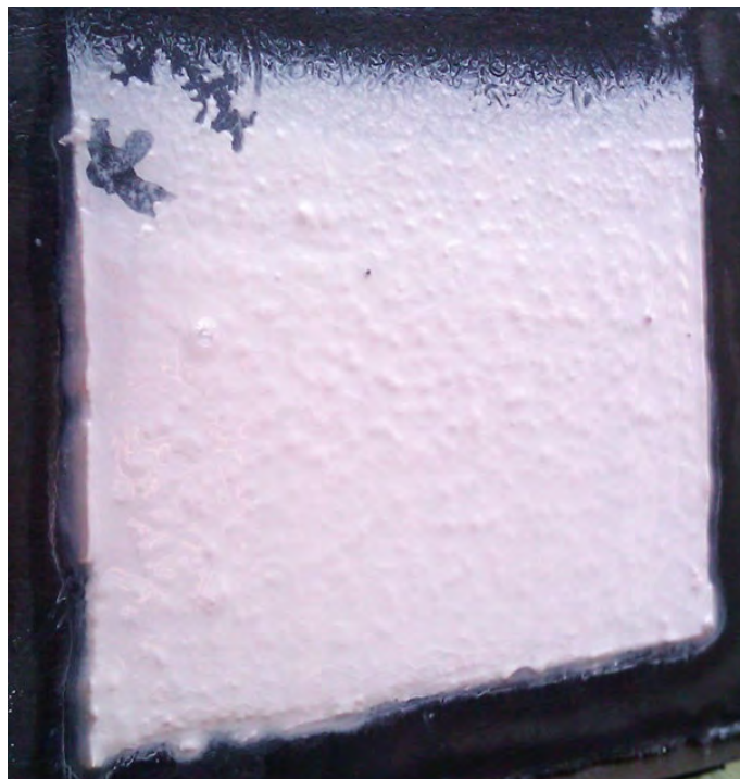
Abbildung 4.38: Abscheidung, erzielt aus CR10-Suspension mit 16 Gew.-%, bei 3,85/-34,65 V, t_1/t_2 = 4 , f = 50 Hz, Abscheidezeit = 10 min, d = 18 mm
