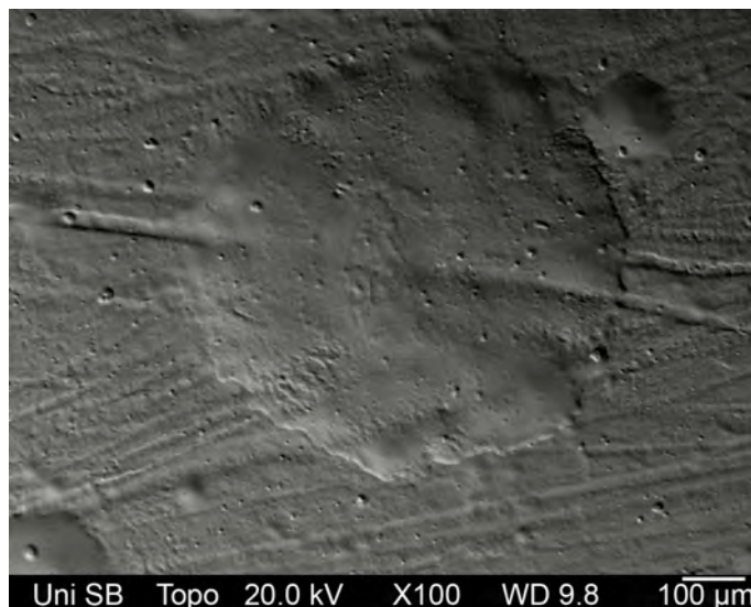
Abbildung 4.48: Grünkörper, abgeschieden aus SM8-Suspension mit 500 \mu\text{m} -Punktelektrode auf Graphitfolie, U_1/U_2 = 1,9/-17,1 V, U_2/U_1 = 9 , t_1/t_2 = 4 , f = 450 Hz, Abscheidezeit= 1 min, d = 200 \mu\text{m} , REM-Aufnahme im Topografiemodus
