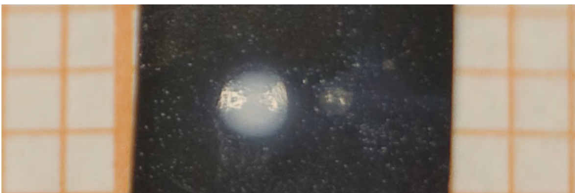
Abbildung 4.43: Grünkörper, abgeschieden aus SM8-Suspension mit 500 \mu\text{m} -Punktelektrode auf Dialysemembran, U_1/U_2 = 3,8/-34,2 V, U_2/U_1 = 9 , t_1/t_2 = 4 , f = 150 Hz, Abscheidezeit= 1 min, d = 400 \mu\text{m}
