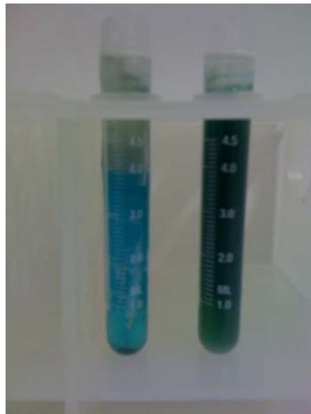
Abbildung 24: \text{Fe}_3\text{O}_4 -Nanopartikel NP10-D1-B in Suspension. Links: 4 Wochen alte Charge, rechts: neu produzierte Nanopartikel.
