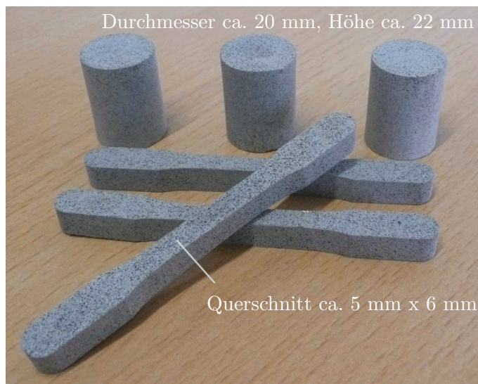
Abbildung 4.3: Gesinterte Zug- und Druckprüflinge
