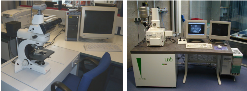
Abbildung 4.4: a) Auflichtmikroskop b) Raster-Elektronen-Mikroskop
