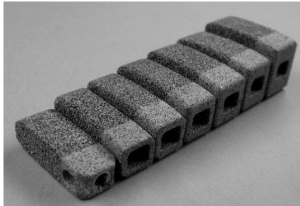
Abbildung 1.7: Titanschaum-Implantate für die Wirbelkörperfusion der Lendenwirbelsäule (IMWINKELRIED [39])
