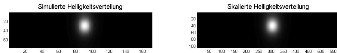
Abbildung F-3: links: simulierte Helligkeitsverteilung einer LED; rechts: skalierte Helligkeitsverteilung einer LED
