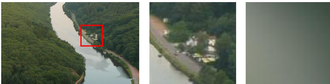
Abbildung 2-14: links: betrachteter Bildausschnitt; Mitte: vergrößerte Darstellung des hellen Objekts; rechts: gleicher Bildausschnitt gefiltert mit einem Tiefpass
