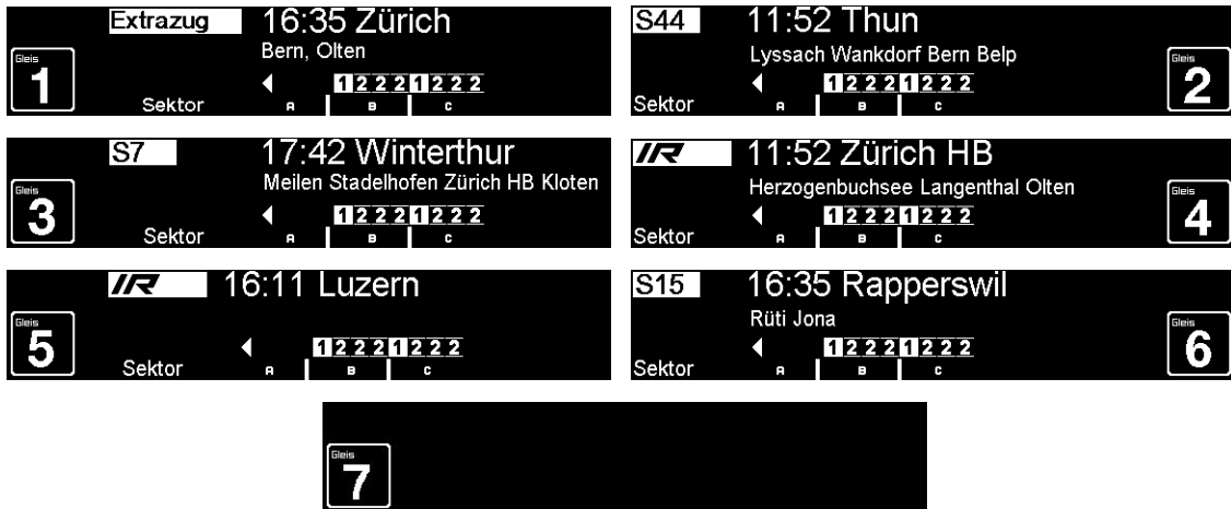
Abbildung 8-2: Test-Set für die Direct-Lit-Signalanzeige
