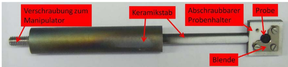
Abbildung 67: Abschaubarer Probenhalter mit halbkreisförmiger Edelstahlblende und montierter Probe. Der Probenhalter wird an einem Keramik-Stab fixiert, welcher mit dem Manipulator verschraubt werden kann.
