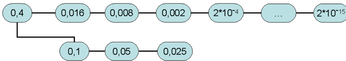
Abbildung 2.4.2a: Schematische Darstellung der Verdünnungsreihen für die ZrO_2 -NP in 10%iger Essigsäure und TODS-stabilisierte ZrO_2 -Suspension.
