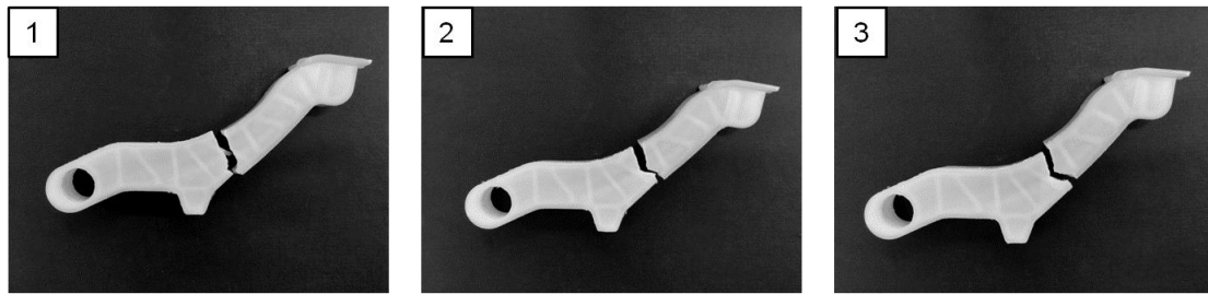
Abbildung 4.24: Bruchbilder der PP-GF Gaspedalversuche
