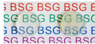
Abbildung 4.81: Vergleich eines gefärbten Glases (rechts) mit einem Transparenten (links)
