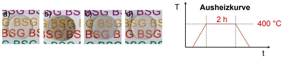
Abbildung 4.62: Sinterung: a) Unbehandeltes Pulver an Luft, b) Unbehandeltes Pulver in Helium-Atmosphäre, c) Thermisch vorbehandeltes Pulver (2 h, 400 °C) in Heliumatmosphäre, d) Thermisch vorbehandeltes Pulver (2 h, 400 °C) an Luft gesintert
