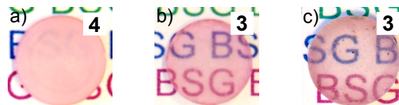
Abbildung 4.67: Variation der Tränkzeit: a) 60 min ( 800\text{ }^\circ\text{C} ); b) 60 min und c) 30 min (je 900\text{ }^\circ\text{C} )
