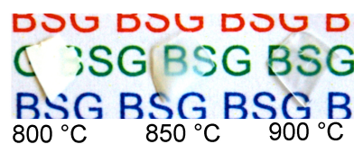
Abbildung 4.51: Sinterergebnisse der aus den Mini-Suspensionen abgeschiedenen Grünkörper
