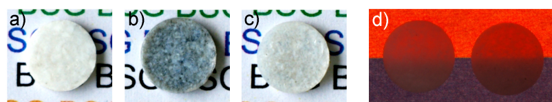
Abbildung 4.25: Sinterung bei 800 °C, 10 mm/min: a) Pressling an Luft, b) Pressling in He-Atmosphäre, c) ausgeheizter Pressling in He-Atmosphäre, d) Probe aus a) (links) und c) (rechts) im Durchlicht
