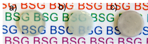
Abbildung 4.83: Sinterproben: a) 800\text{ }^\circ\text{C} ; b) 900\text{ }^\circ\text{C} ; c) an He-Atmosphäre bei 800\text{ }^\circ\text{C}
