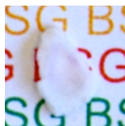
Abbildung 4.56: Foto eines mit einer KOH-Ausgleichslösung abgeschiedenen Sinterkörpers
