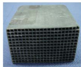
Abb. 5-10: Beschichtungsergebnisse verschiedener Filter nach Zweifachbeschichtung
