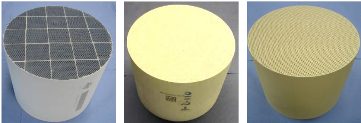
Abb. 5-7: Verwendete Filter im Großformat; links: SiC, mitte: AlTi, rechts: Cordierit
