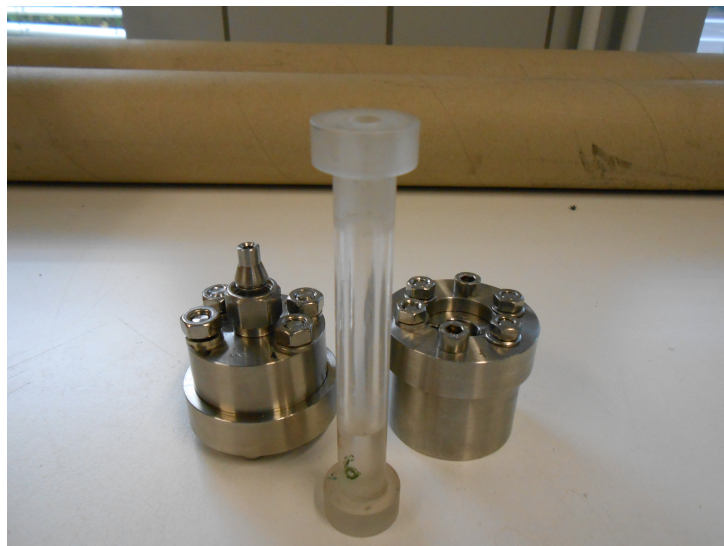
Abbildung 80: Saphireinkristall mit Stahlhalterung, demontiert
