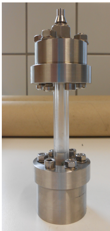
(a) Saphireinkristall mit Stahlhalterung, montiert
