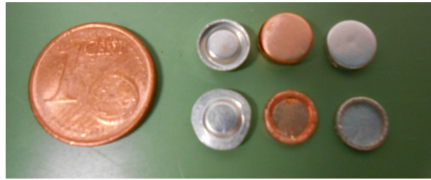
Abbildung 75: Aufnahme der DSC Probengefäße. Von links nach rechts: „Ufo“-Tiegel, Kupfertiegel, Aluminiumtiegel. Unten jeweils verkrampt, oben unverkrampt. 1-Centmünze als Grössenvergleich.
