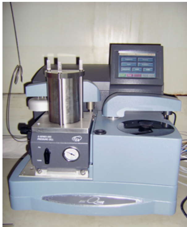
Abbildung 74: Aufnahme der DSC von TA mit Druckzelle
