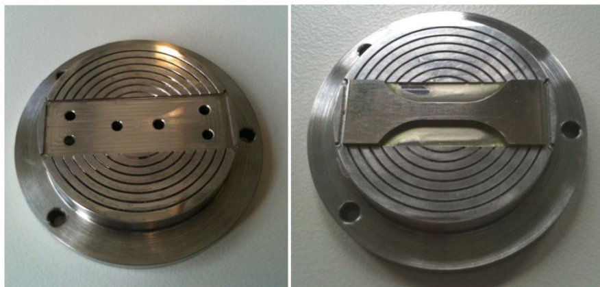
Probenhalter für den mechanischen Schleif- und Politurprozess
