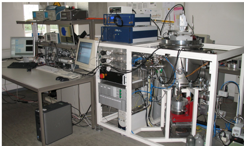
Abb. 5.1: Gesamtübersicht des Messplatzes (links: elektrische Messtechnik, rechts: Vakuumanlage, rechts oben: Laservibrometer).
