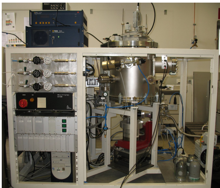
(a) Frontalansicht: Links Steuerungseinheiten und Gaszuführung, rechts Rezipient, oben Laservibrometer.
