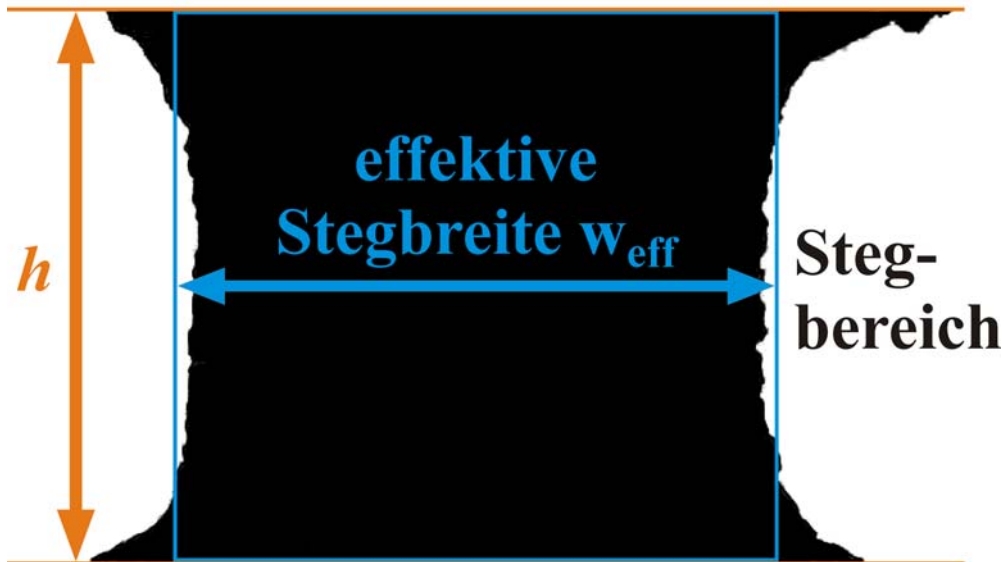
Abbildung 3.14: Mit einer Bildanalyse-Software bearbeitete REM-Aufnahme des Stegbereichs einer m-SCS. Die „wahre Stegfläche“ ist schwarz und die Steghöhe h in orange dargestellt. Der flächen-äquivalente, rechteckige Stegquerschnitt, welcher in der FEM-Simulation benutzt wurde, ist blau gekennzeichnet und bestimmt so die effektive Stegbreite w_{\text{eff}} .
