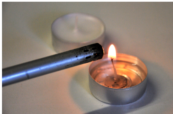
Abbildung 6.18: Selbstgebaute Öllampe aus Teelichtmantel, Docht und Sonnenblumenöl.
