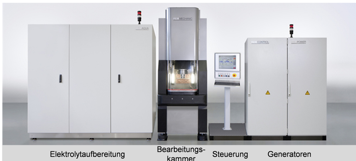
Abbildung 5-12: Untersuchte Maschine PEM 600 mit den Anlagenteilen (PEMTec 2015b)
