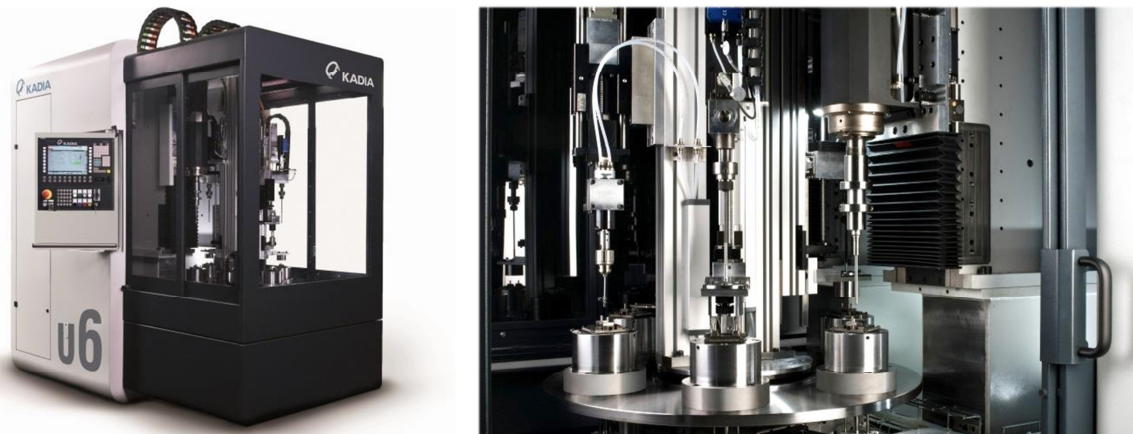
Abbildung 5-21: Untersuchte Kadia 2LH 60/350 R (links), Rundtisch im Bearbeitungsraum mit sechs Bearbeitungsstationen (rechts) (Kadia 2014)
