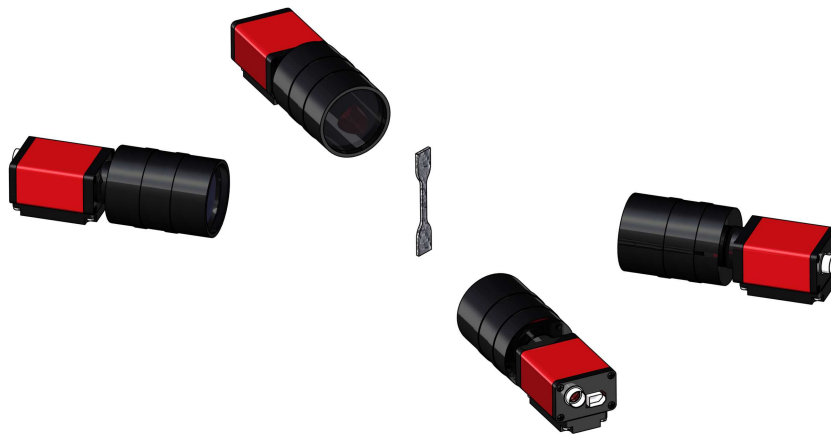
Abbildung 5.14: Anordnung des 4-Kamera-Systems mit der Probe im Zentrum.
