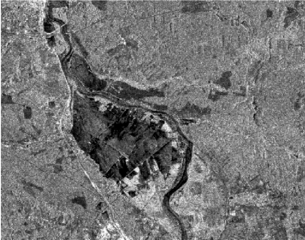
Abb.: Radar-Aufnahme des ERS-2-Satelliten vom 5.8.97. Abgebildet ist die Region der Grenzoder im Bereich Ziltendorfer Niederung, die nach den Deichbrüchen vom 23. und 24.7.97 auf einer Fläche von etwa 6000 ha überflutet war (Wasserflächen dunkelgrau).
